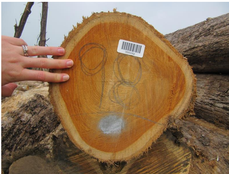
Kuva 2. Tiikin poikkileikkaus, jossa sydänpuu ja pintapuu erottuvat selkeästi. (Apical Re-forestadora S.A. 2017)
