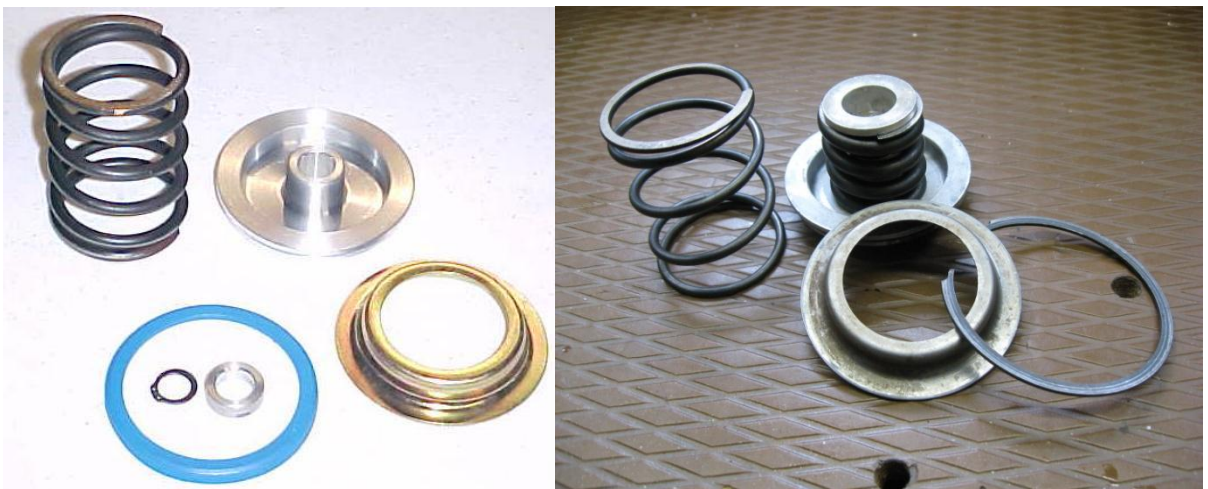
Kuvio 24. Kilpakäyttöön tarkoitettu takaservo ja alkuperäinen takaservo
