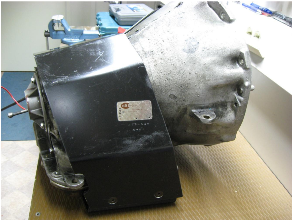
Kuvio 3. A-727 -vaihteiston alumiininen räjähdysuoja
