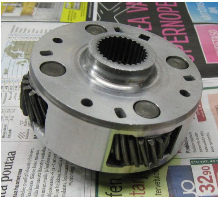
Kuvio 28. Etummainen planeetta neljällä planeettapyörällä
