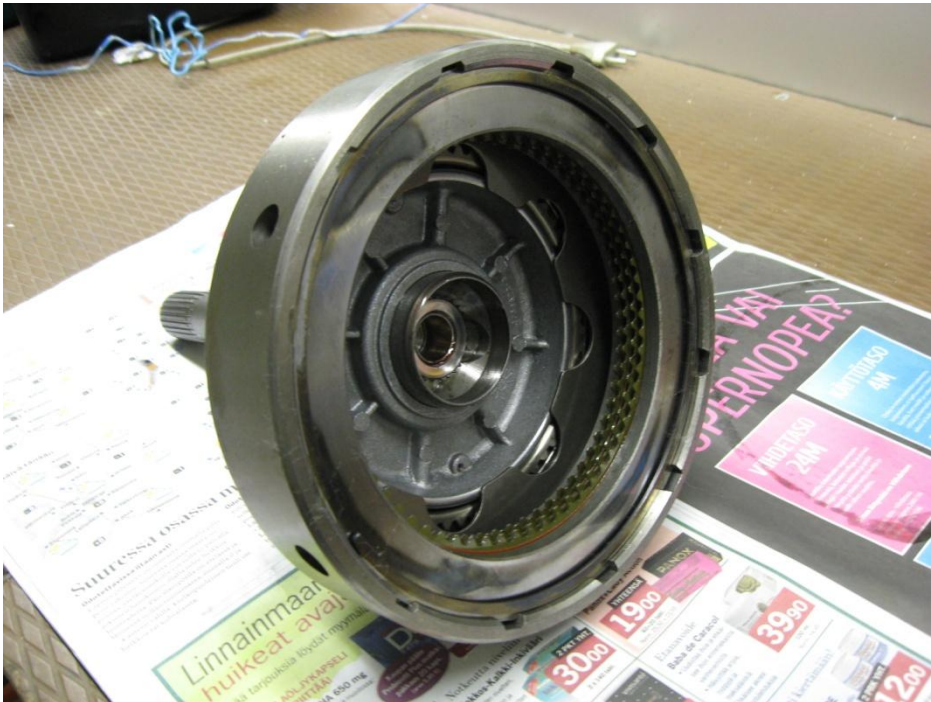
Kuvio 26. Nelilevyinen vakiokytkinrumpu koottuna
