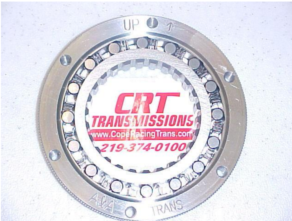
Kuvio 32. Ruuviliitoksella kiinnitettävä vapaakytkin, jossa on 16 rullaa. (CRT)
