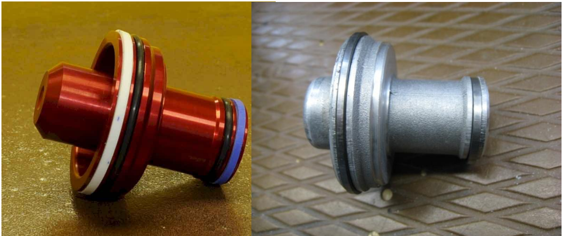
Kuvio 23. Kilpakäyttöön tarkoitettu akkumulaattori neljällä tiivisterenkaalla ja alkuperäinen kahdella tiivisterenkaalla
