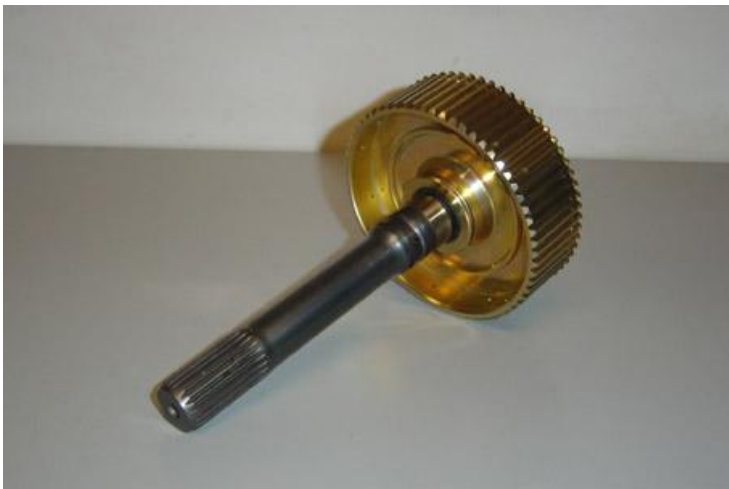
Kuvio 9. 300M-teräksestä valmistettu sisääntuloakseli ja kytkinrumpu (Coan Racing)
