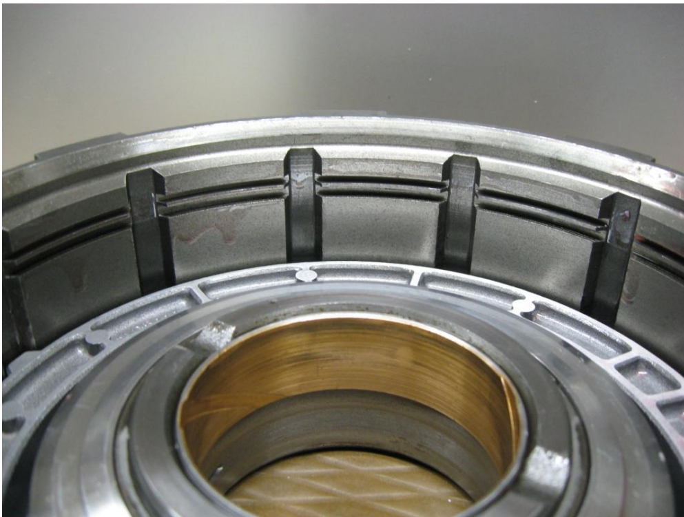
Kuvio 10. 3 tai 4 kytkinlevylle tarkoitetut lukkorengasurat sekä alumiininen mäntä
