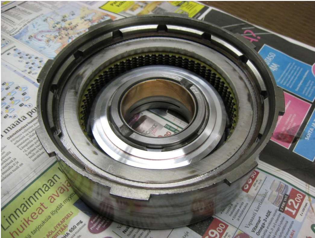
Kuvio 12. Valurautainen etummainen kytkinrumpu koottuna
