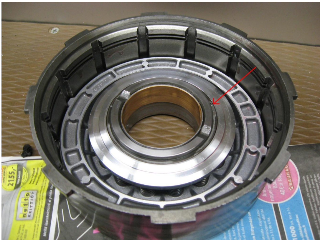
Kuvio 16. Alumiininen pidätinlevy asennettu, nuolella on osoitettu lukkosokalle koneistettu ura.
