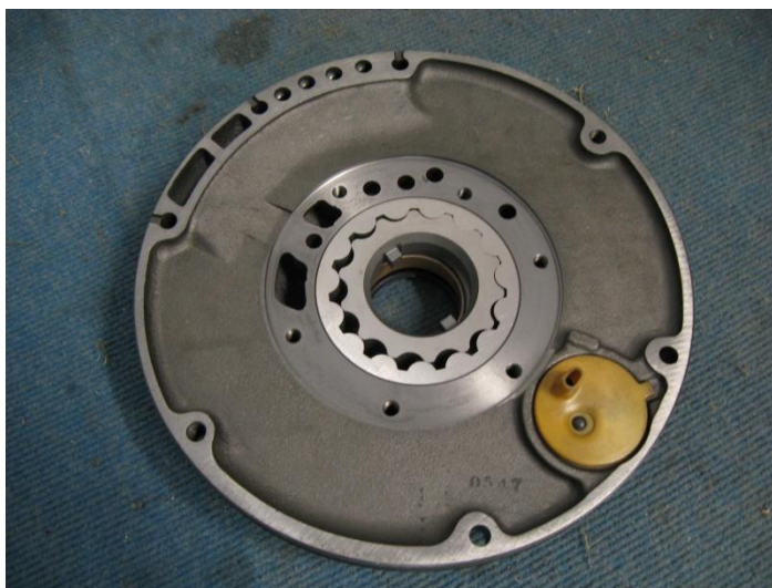
Kuvio 5. Öljypumpun hammaspyörät asennettuna öljypumpun runkoon
