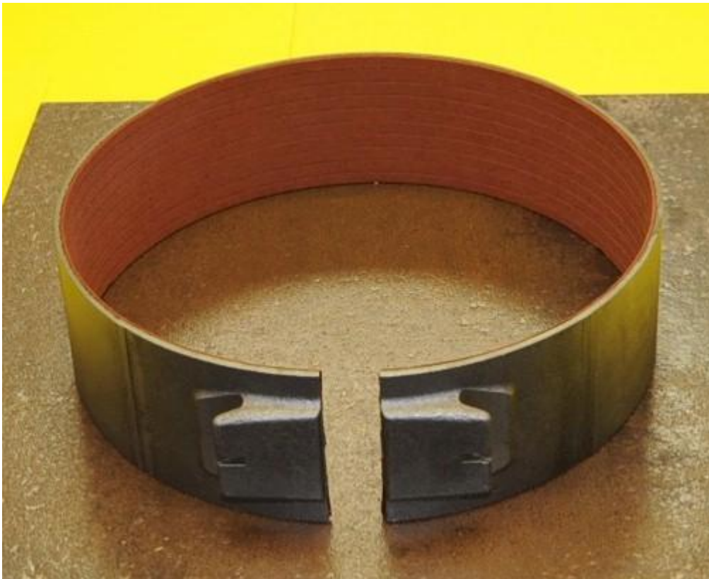
Kuvio 18. Jäykkärunkoinen Red Eagle -pinnoitteella varustettu jarrupanta
