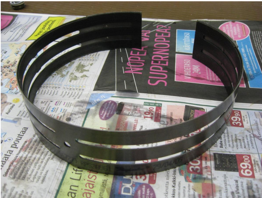
Kuvio 17. Alkuperäistyyppinen hiilikuitupinnoitteinen flex-band -jarrupanta
