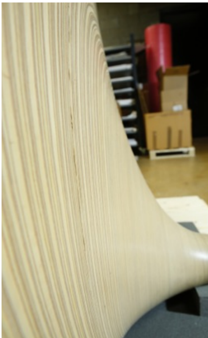
Kuva 12a & 12b, Simpukka-veistoksen viiluvaurioita.
