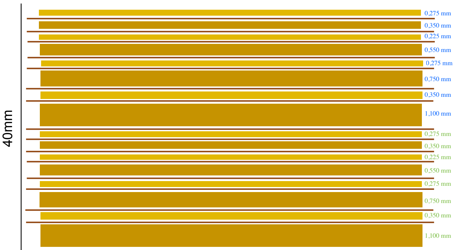
Kuva 8. Ladontaohjeen mukainen havainnekuva A-tyypin vanerin rakenteesta. Viiluja ladotaan samalla rytmillä, kunnes levyn paksuus on saavuttanut 40mm.
