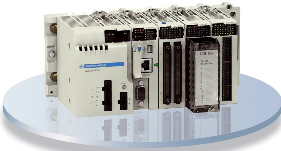
Kuva 9. Telemecaniquen ohjelmoitava logiikka. (Telemecanique 2007.)
