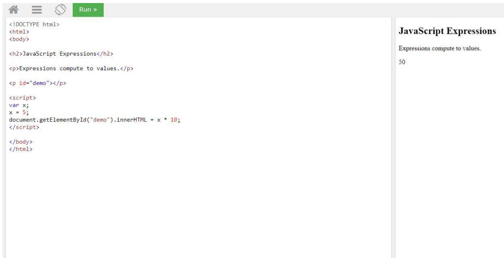
KUVA 3 Esimerkki JavaScript-ohjelmointikielestä. JavaScript on ohjelmointikieli, jolla luodaan dynaamista toiminnallisuutta verkkosivulle ja hallitaan sen elementtien käyttäytymistä.
