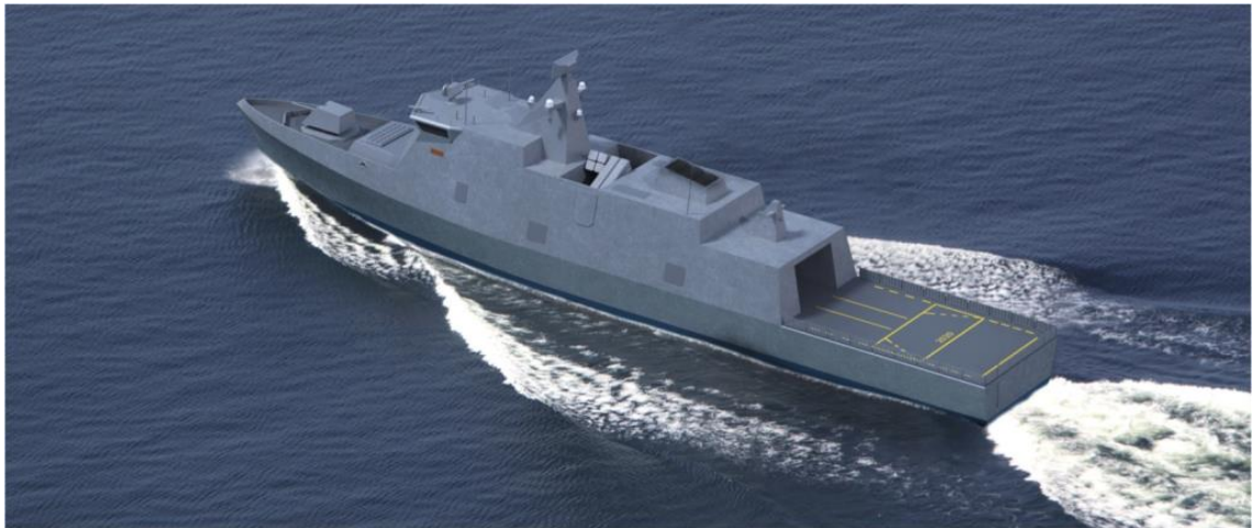
KUVA 4. Havainnekuva tulevasta Laivue 2020 -aluksesta. Takaosassa näkyy helikopterin laskeutumisalusta ja sääsuoja (Pulkki 2015)
