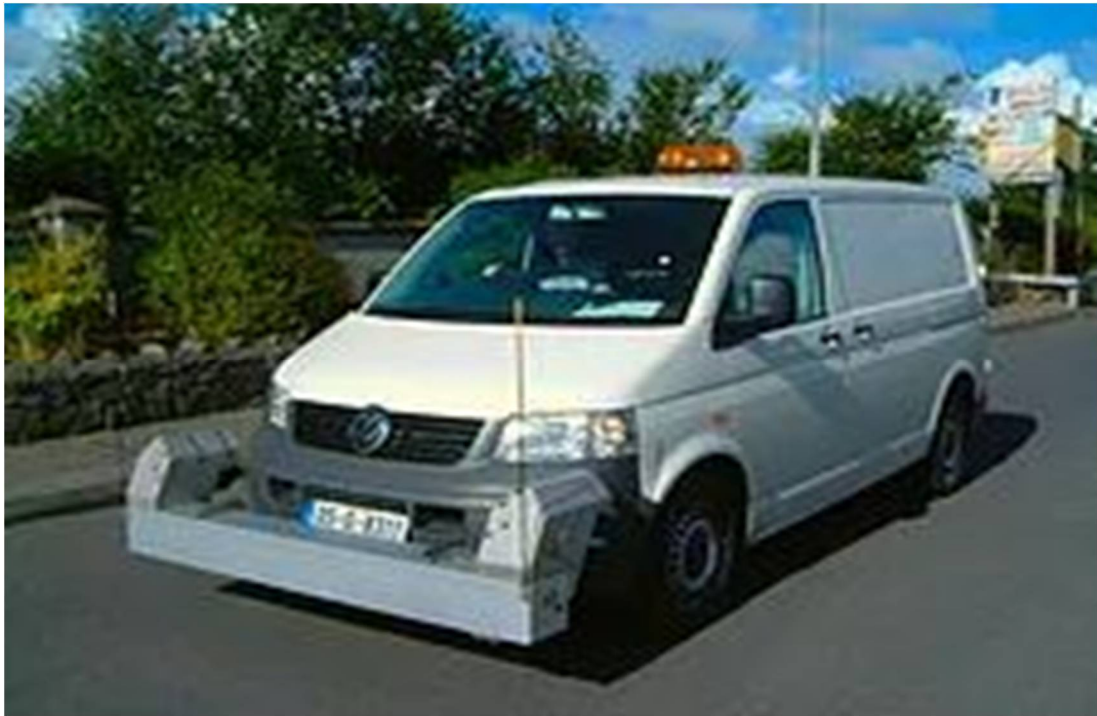
Kuva 6. Päällysteen urautumista mitataan ajoneuvolaitteistolla. (Kuva: Dynatest)
