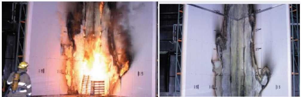
Kuva 4. Standardin mukaista Kingspan Firesafe -tuotesarjan testausta /6 /.
