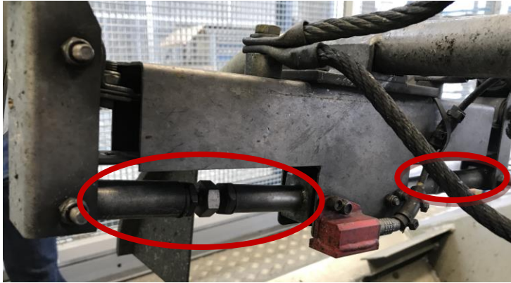
Kuva 19. Kuvassa virroittimen kelkan vasen puoli. Punainen palikka kuvan alareunassa on toinen virroittimen kiihtyvyyssantureista. Kuvassa näkyy myös etummaisien ja takimmaisien hiilen kontaktikulmien säätötangot punaisien alueiden sisällä.
