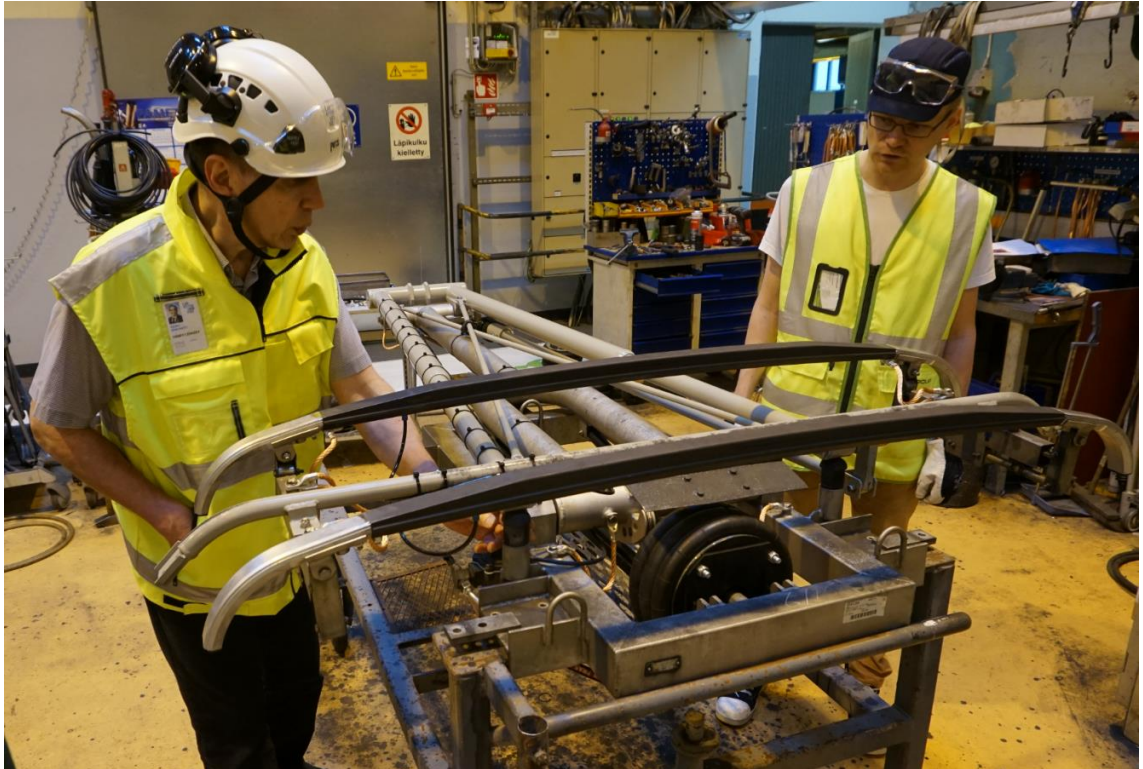
Kuva 14. Ylitarkastaja Juha-Matti Vilppo (Liikennevirasto) vasemmalla ja johtava asiantuntija Samuli Suuriniemi (VR) oikealla, tarkastelemassa SR2-veturin virroitinta.
