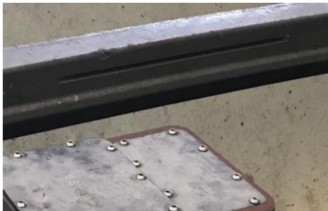
Kuva 17. Kulumaa indikoiva ura virroittimen hiilessä.
