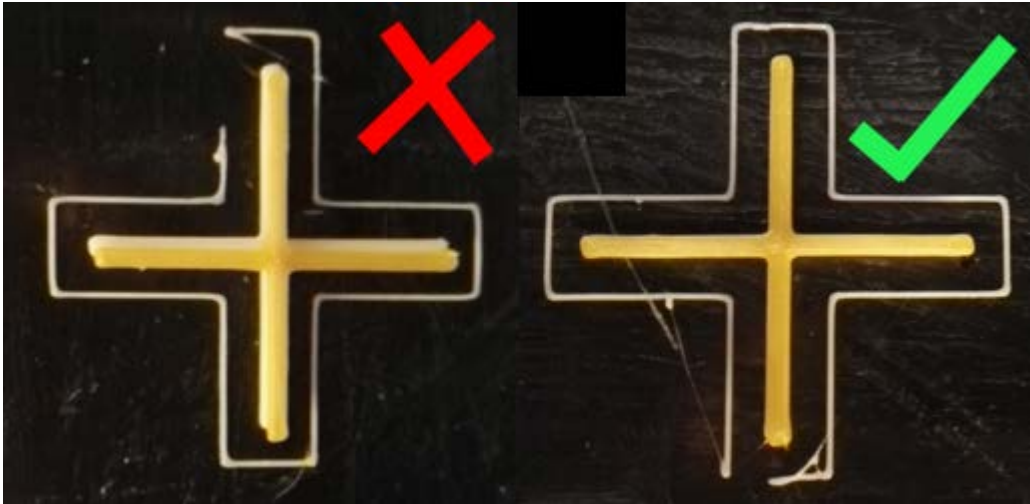
Kuva 65. Suutinten keskinäinen kohdistus
