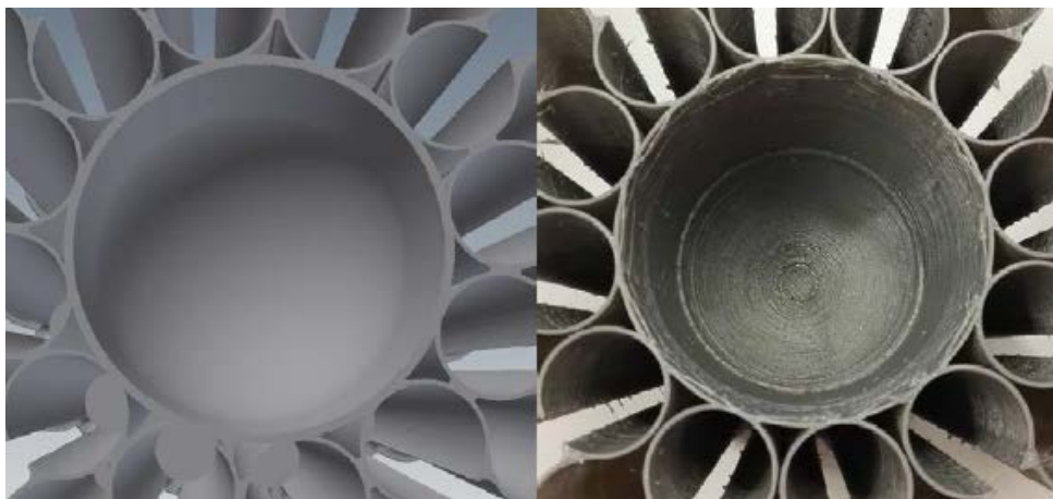
Kuva 34. Pinnanlaatu CAD-mallissa (vasen) ja tulostetussa (oikea) kynätelineessä
