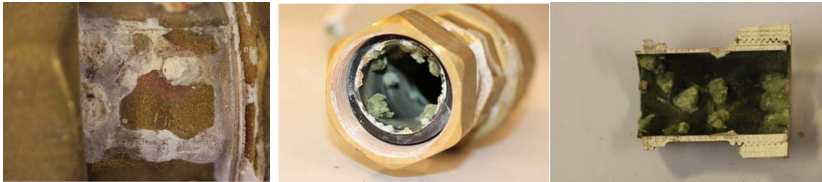
Kuva 5. Kuvissa näkyy viiden käyttövuoden jälkeen sinkinkatoa liittimen pinnalla (marenkimainen saostuma sekä punertavuus liittimen pinnalla, kuva vasemmalla). Liittimessä näkyy edelleen saostumaa sisäpinnalla (kuva keskellä) sekä poikkileikkauksuvassa (kuva oikealla). (VTT 2016)
