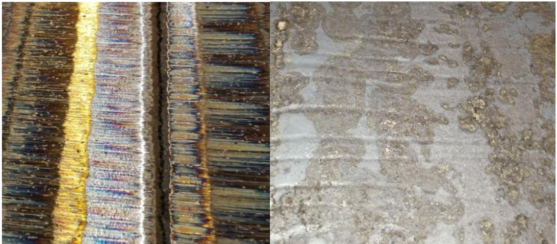
Kuva 10. Vasemmalla halkeama, oikealla oskillointijälkeä
