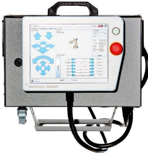
Kuva 19. Robotin ohjauskaappi sekä opetusyksikkö (Universal Robots 2017b).
