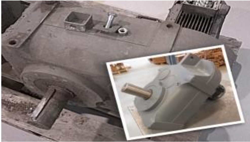
Kuva 7. SEW-Eurodriven vaihteen uudelleenvalmistusta
