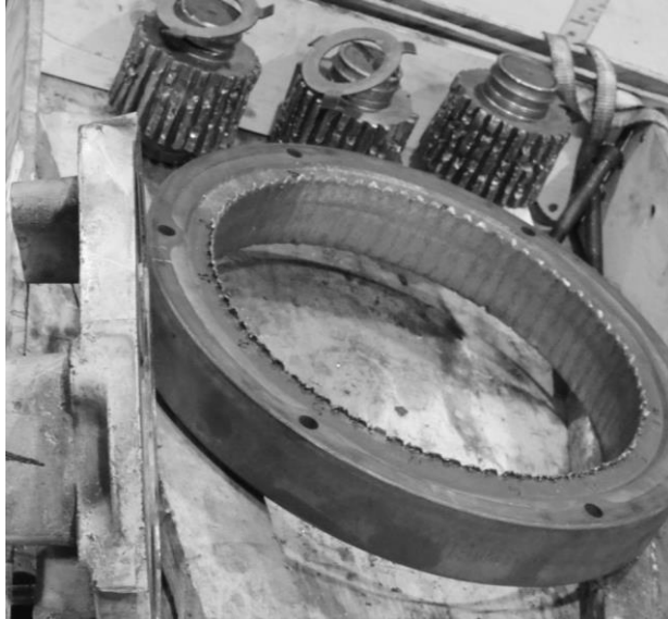
Kuva 15. Loppuun kuluneita planeettavaihteen hammastettuja osia
