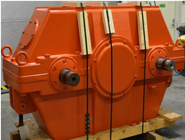
Kuva 18. Peruskunnostettu vaihde valmiina lähetettäväksi asiakkaalle
