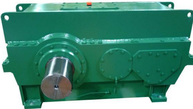
Kuva 20. Tilalle suunniteltu ja valmistettu uusi rakenteeltaan kestävämpi vaihde
