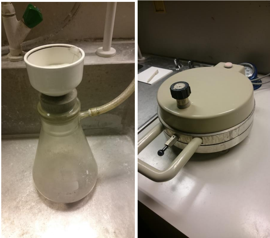
KUVA 1. Büchner-suppilo ja imupullo sekä alipainelämpökuivain (Kuvat: Laura Warjus 2017)
