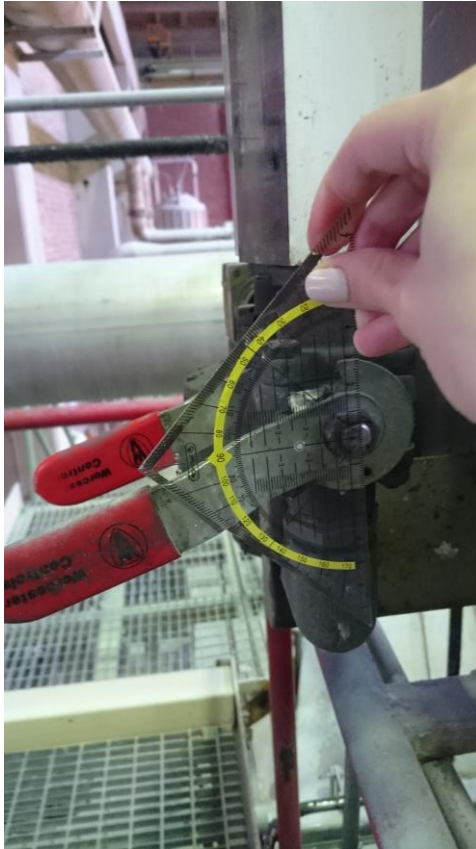
KUVA 6. Käsiventtiilien kulmien mittaus (Kuva: Laura Warjus 2017)
