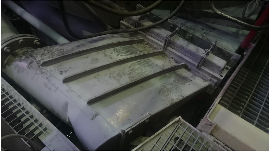
KUVA 4. Kennojen 1 ja 3 massan syöttö ja ilmastus. (Kuva: Laura Warjus 2017)
