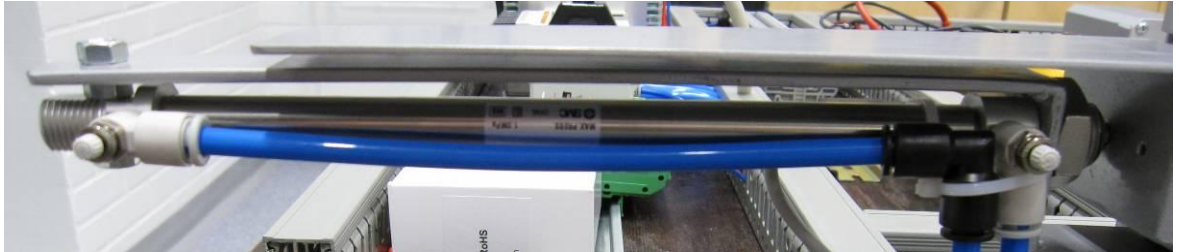
KUVIO 6. Kaksitoiminen sylinteri ja sen kiinnitys torniin
