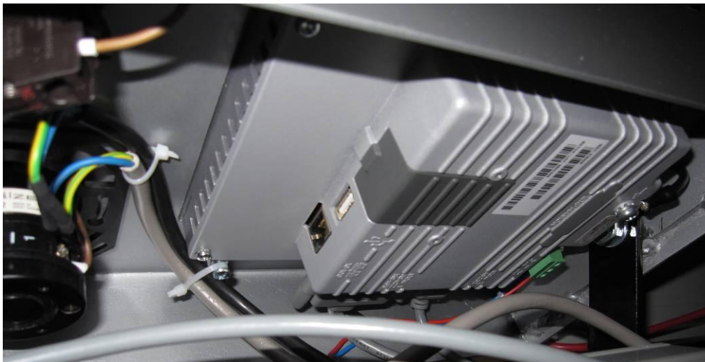
KUVIO 21. Operointipaneelin liitännät ja ohjauspöydän kallistuksen säätö
