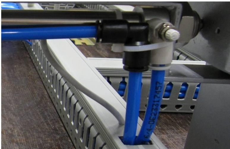
KUVIO 18. Reed-anturin kiinnitys tornin sylinteriin
