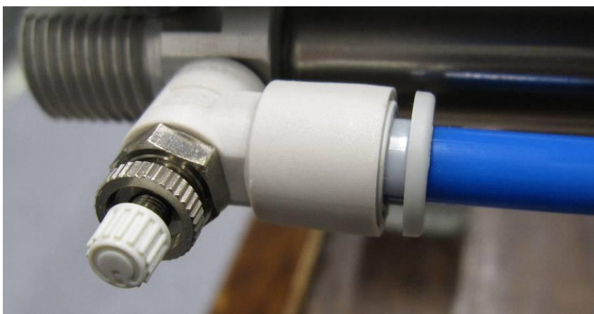
KUVIO 9. Vastusvastaventtiili lisätynä kaksitoimiseen sylinteriin
