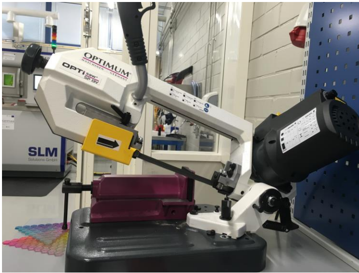
KUVA 19. Työtasolla oleva vannesaha (Kuva: Surma-aho, 2016)
