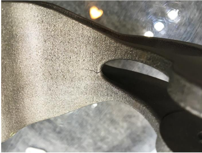
KUVA 5. Kappaleen lämpöhalkeama (Kuva: Surma-aho 2016)
