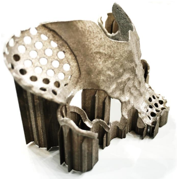
KUVA 3. Automaattinen tukirakenne (Kuva: Surma-aho 2015)
