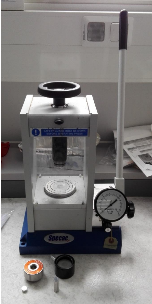
KUVA 15 Prässi ja näytenapin valmistukseen käytetyt muotit
