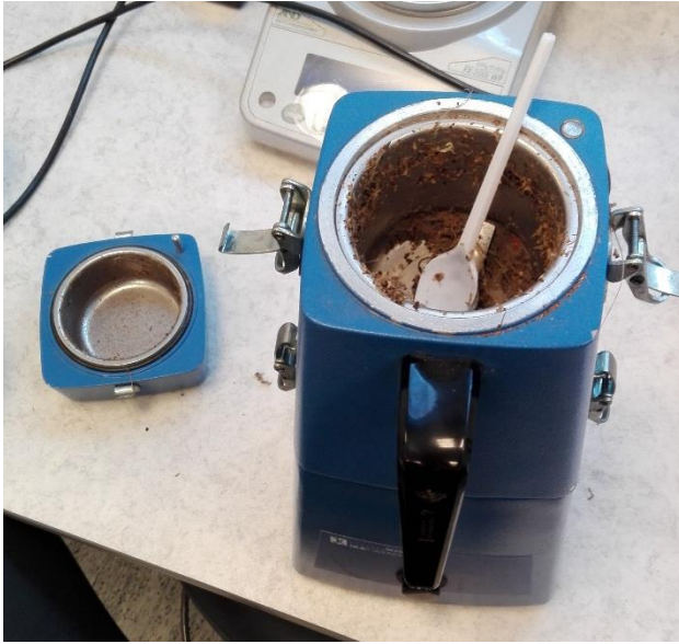
KUVA 7 Mylly, jolla näytteet murskattiin
