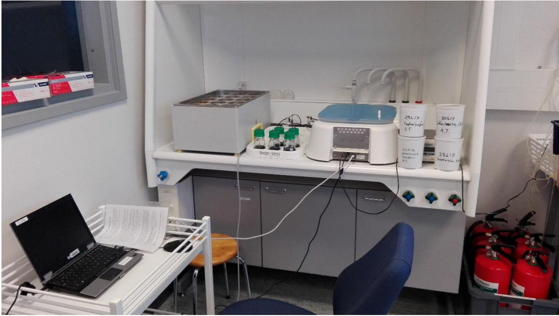
KUVA 6 Mädätyskoelaitteisto sekä välpenäytteet
