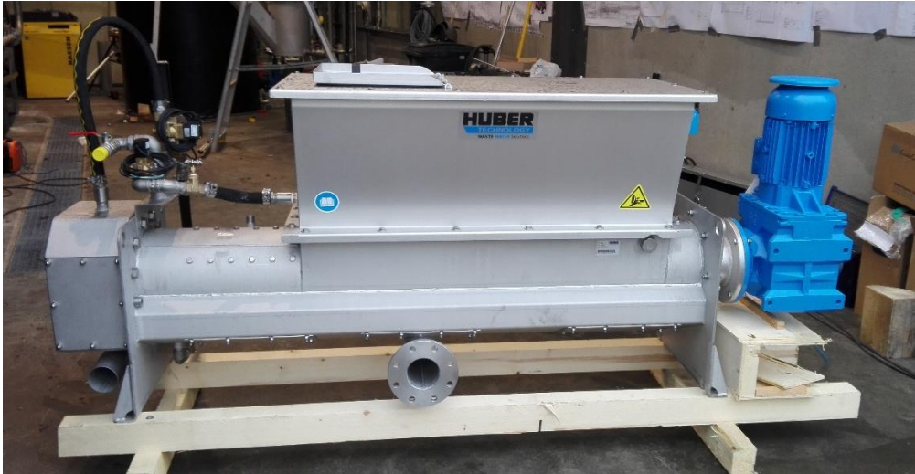
KUVA 3 Oulun Biotehtaalle hankittu välpepuristin
