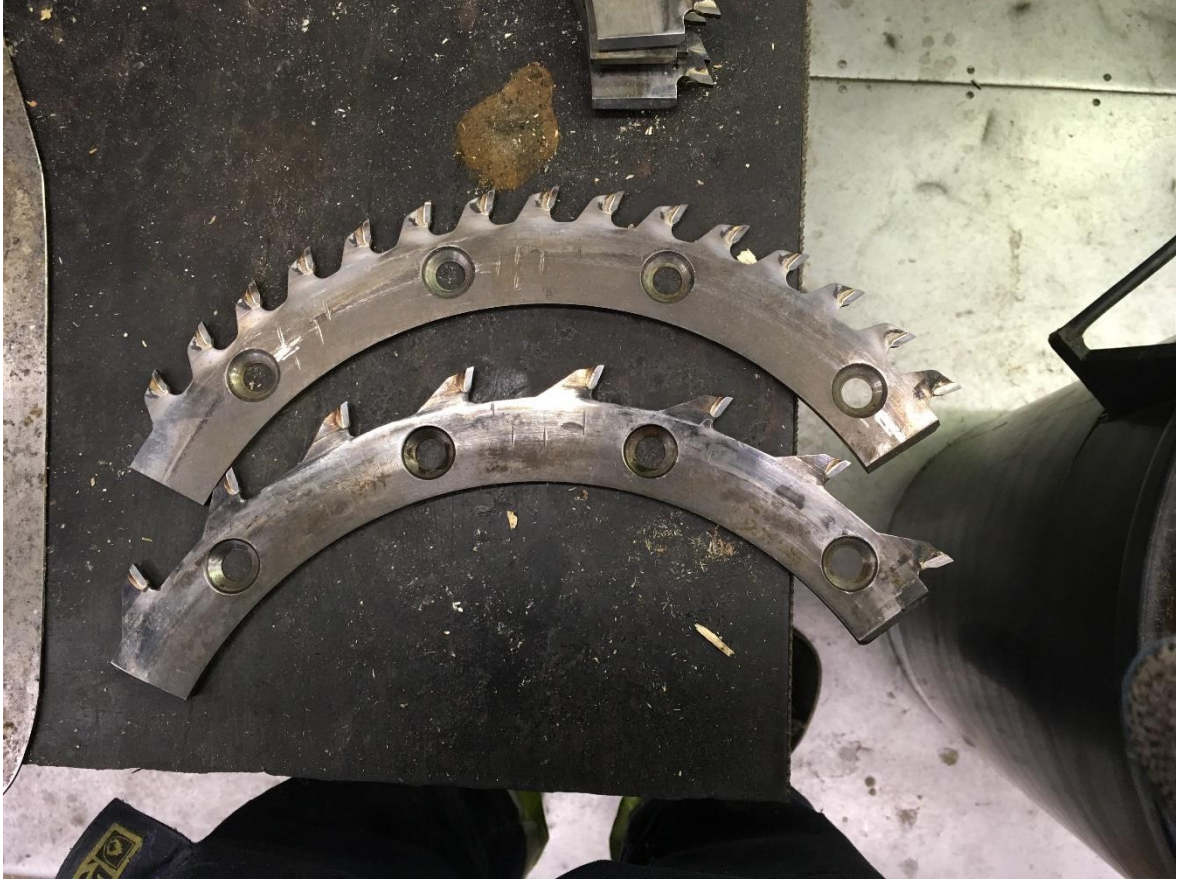
Kuva 7. Uusi teräsegmentti jyrsimiin yläpuolella ja vanha teräsegmentti alapuolella.
