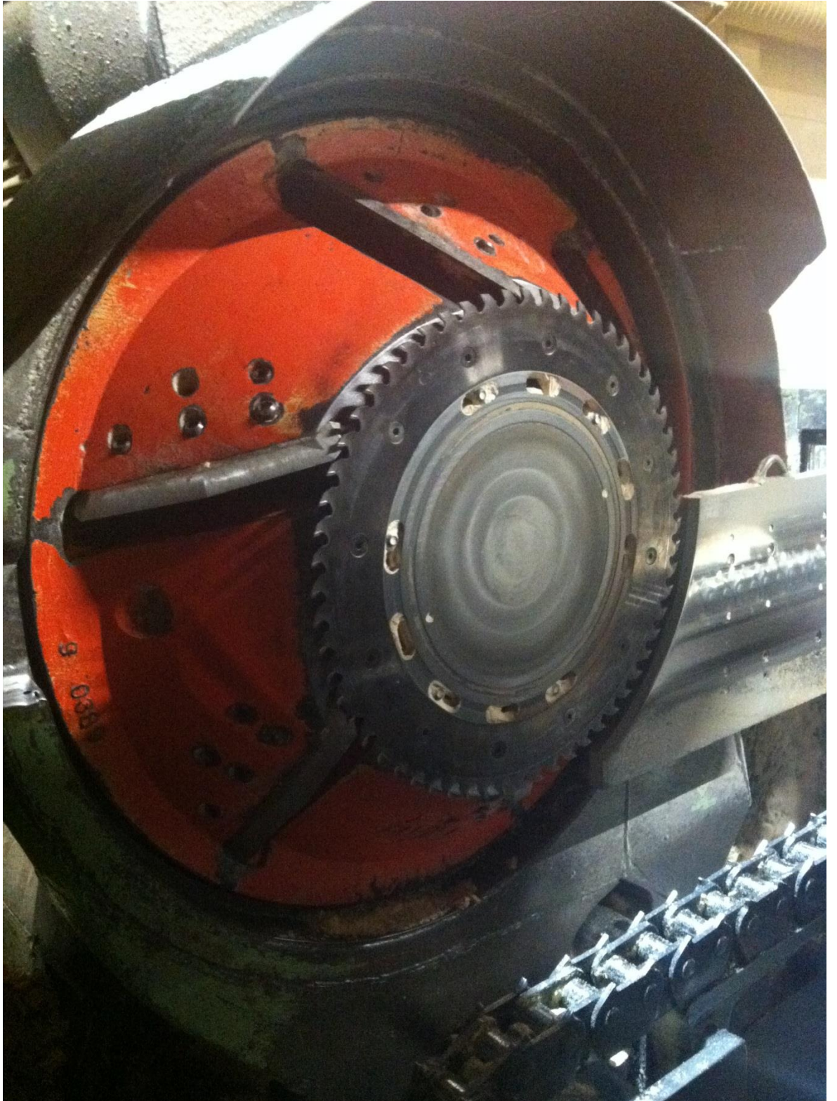
Kuva 1. Pelkkahakkurin segmentti ja haketuspalat(harjaterät)
