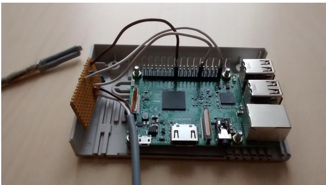
Kuva 9. Lopullinen kytkentä liitettynä Raspberry Pi:hin
