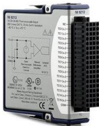
KUVA 3.4. NI-9213-termoparimoduuli (National Instruments 2017).
