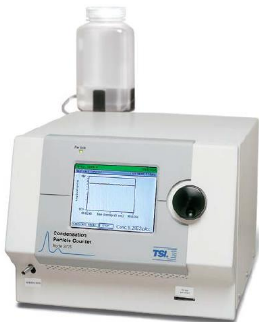
KUVA 4.1. Kondensaatiohiukkaslaskuri, eli CPC (Condensation Particle Counter) (TSI, 2006).
