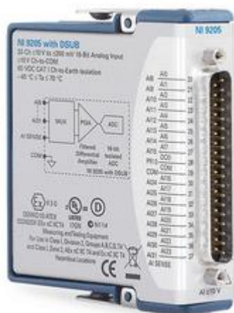
KUVA 3.5. NI-9205-jännitemoduuli (National Instruments 2017).
