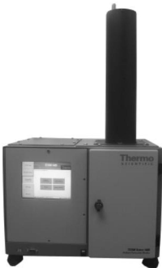
KUVA 4.13. Värähtelevä mikrovaaka (TEOM) (Thermal Fisher Scientific 2008).
