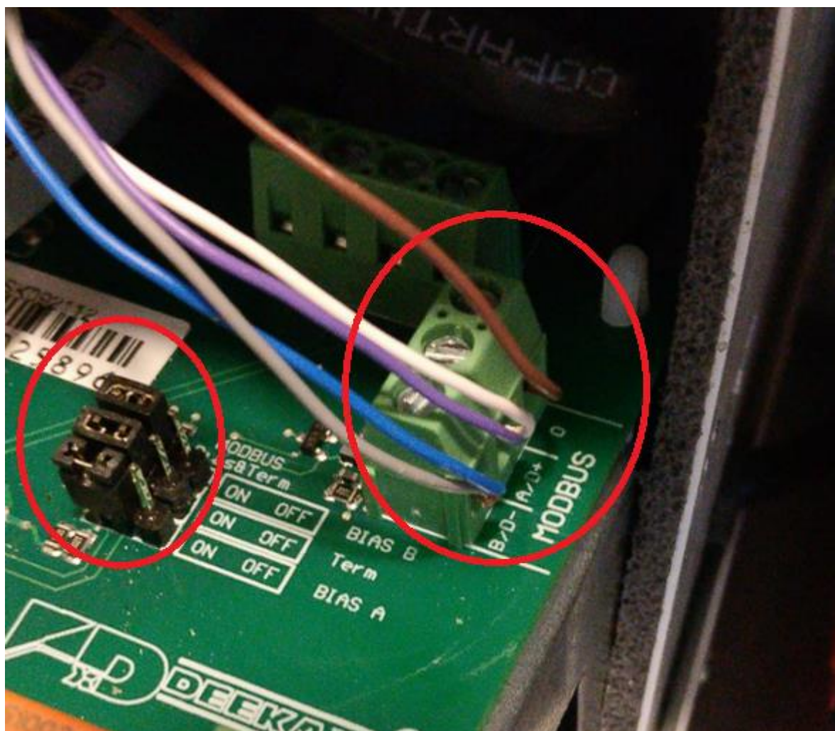
KUVA 5.2. Modbus-väylää varten ilmanvaihtokoneen piirilevyllä kiinnitettävät johtimet RJ50-kaapelista (oikea ympyrä) ja jumper-liittimet biasointivastuksille sekä päätevastukselle (vasen ympyrä) (Miettinen 2017).
