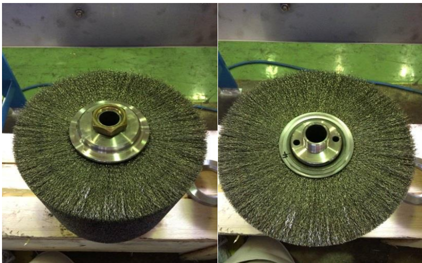
Kuva 19. Lukitusmutterin avaus ja Kuva 19. Avattuna (Heinonen)
