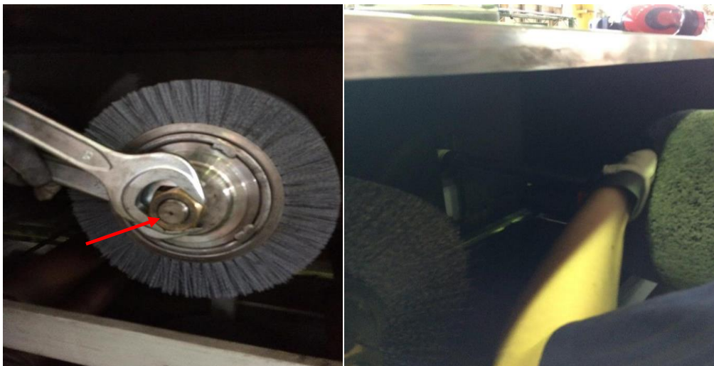
Kuva 16. Harjan lukituksen avaaminen ja Kuva 17. Harjan pois ottaminen (Heinonen)
