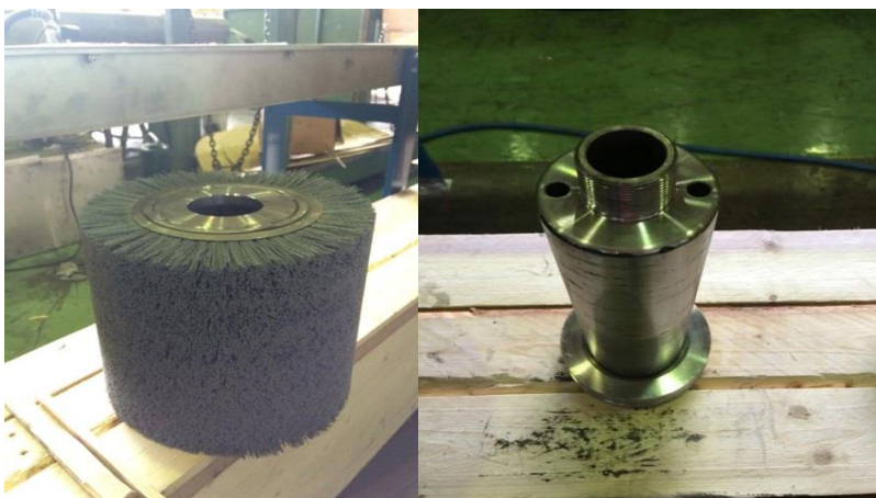
Kuva 20. Uusi Harja ja Kuva 21. Harjan akseli (Heinonen)
