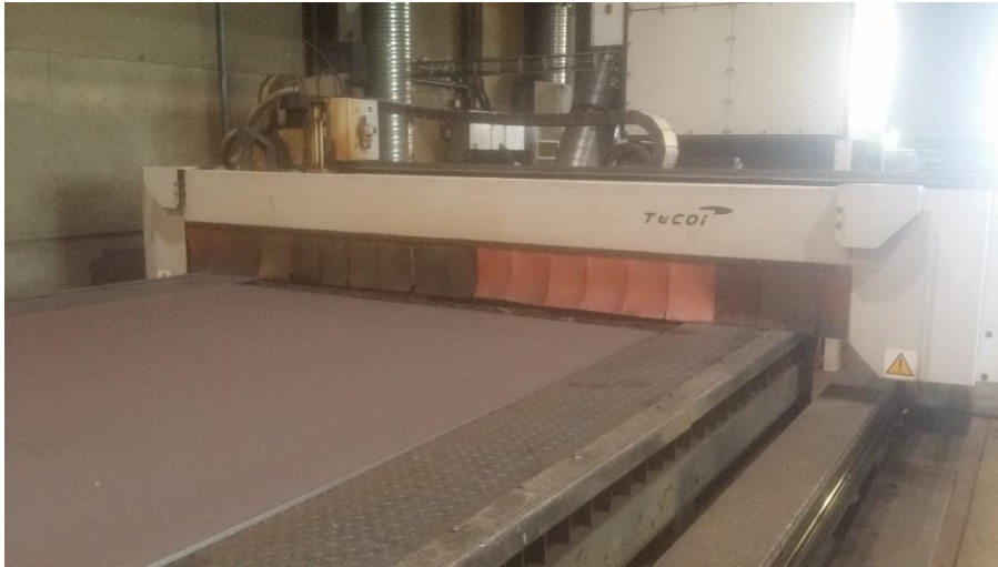
KUVA 2. Tecoi plasmaleikkurin työpöytä ja 10mm panssarilevy leikattavana
