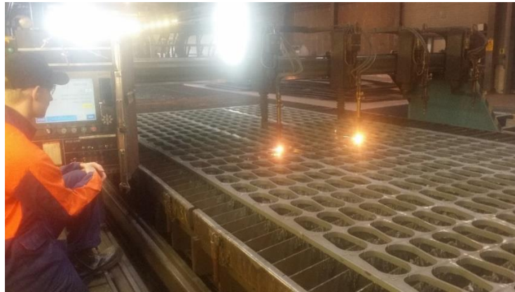
KUVA 1. Burny 10plus Eko CNC-ohjausyksiköllä varustettu kaasuleikkauskone paloittelemassa poltosta jäänyttä levyrankaa
