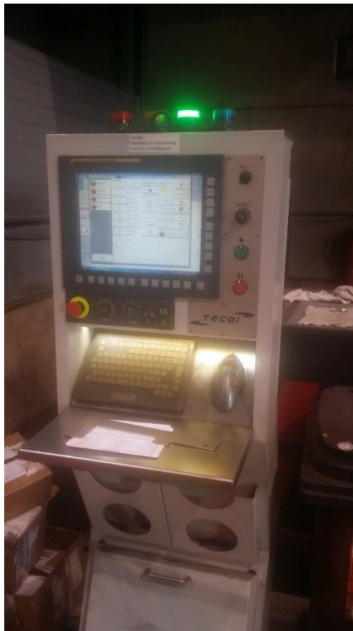
KUVA 3. Tecoi plasmaleikkauspöydän NC-ohjauspaneeli
