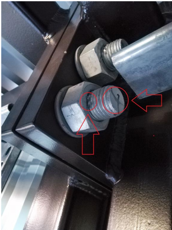
KUVA 3. Ruuvikokoonpanon oikeaoppinen lukitseminen ja merkkaaminen.
