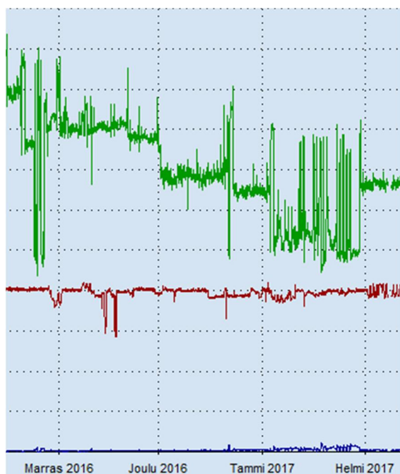
Kuva 20. Kohde A:n meno- ja paluulämpötilat sekä virtaama talvella 2016–2017.
