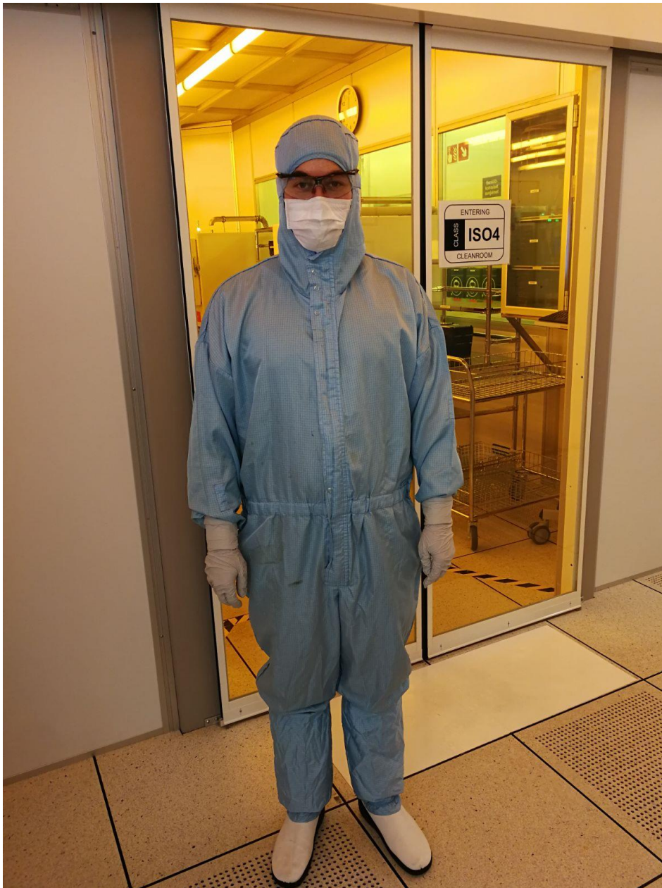
Kuva 4. Työntekijä pukeutuneena puhdistilahaalareihin, taustalla litografian ISO4-puhdistila-alue
