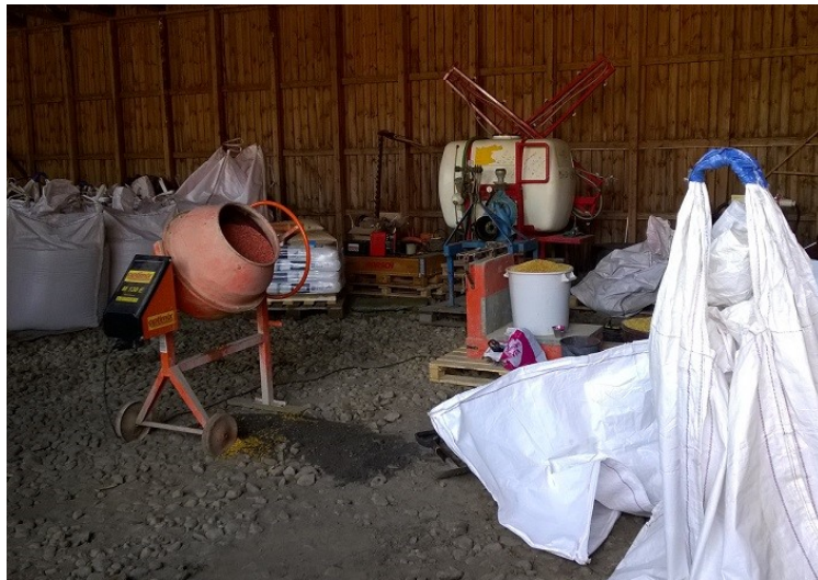
Kuva 3. Pienet erät käsiteltiin betonimyllyn avulla 3.5.2015.
