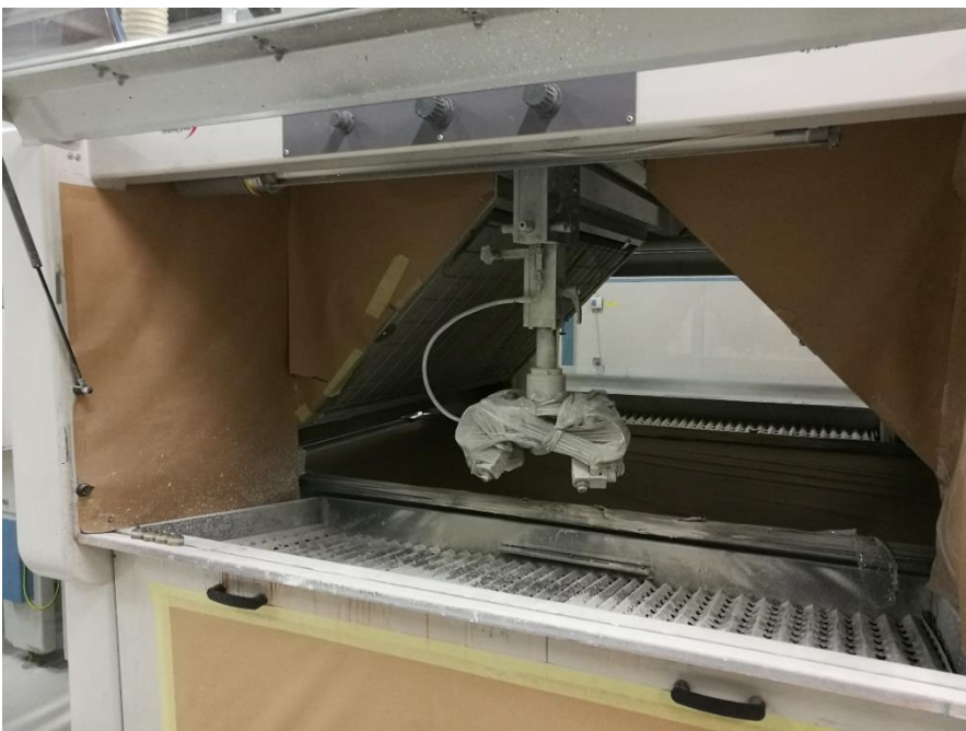
KUVA 5. Cefla Kleenspray 12P -traverssivarsi maalausammiossa.
