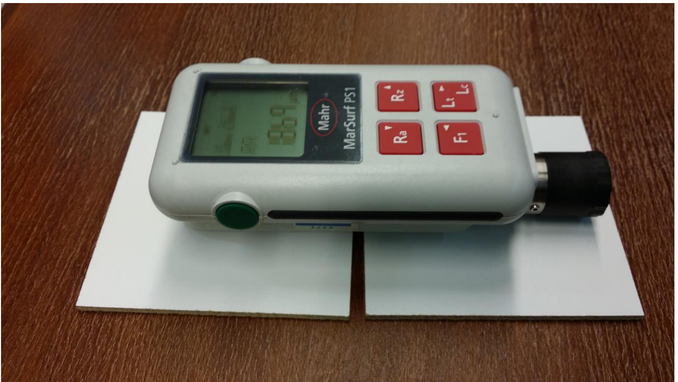
KUVA 10. Elcometer 7061 MarSurf PS1 -karheusmittauslaite.
