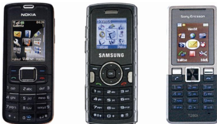
Kuva 10: Nokian 3110 Classic, Samsungin SGH-M110 ja Sony Ericssonin T280i matkapuhelinmalleissa on saman kaavan mukainen numeronäppäimistö. (Kuvat: Tekniikan Maailma nro 8/2009, 39–40.)
