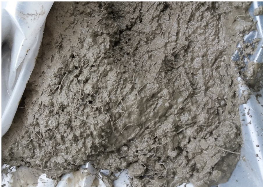
Kuva 9. Betonimassasta erottuvat kuidut.
