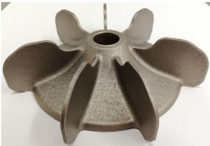
Kuvio 26. Terästuuletin valmistettuna kolmella eri menetelmällä.
