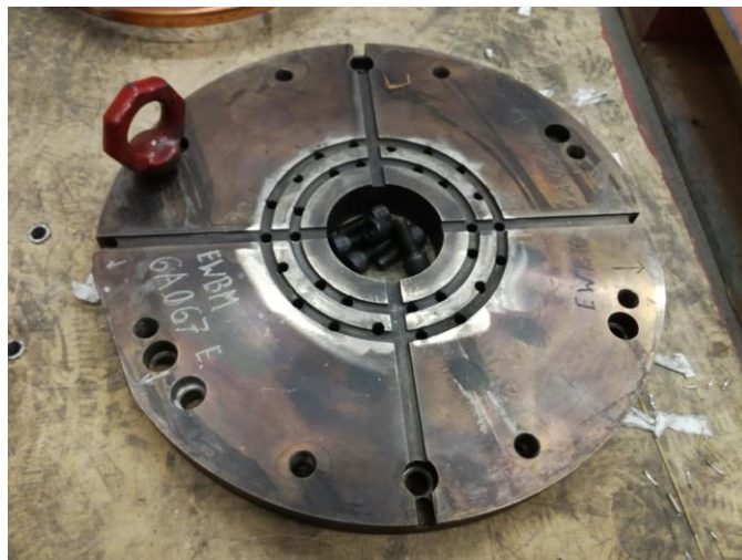
Kuvio 18. Oikosulkurenkaan muotin puolikas, joka mahdollistaa muotin kiinnityksen valukoneeseen.
