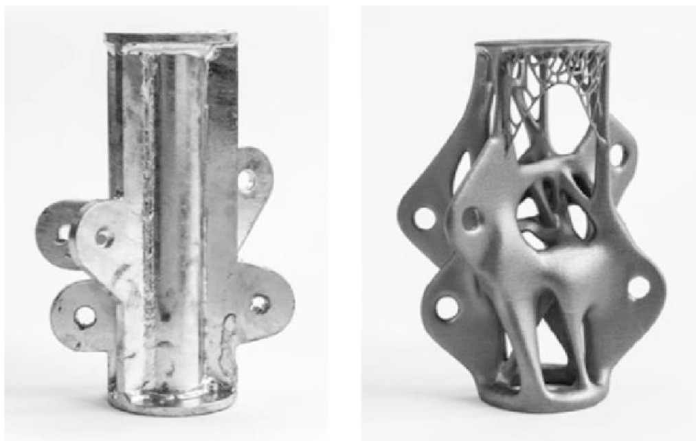
Kuvio 12. Hitsattu kappale sekä topologisesti optimoitu kappale, joka on valmistettu lisäävillä menetelmillä /19/.
