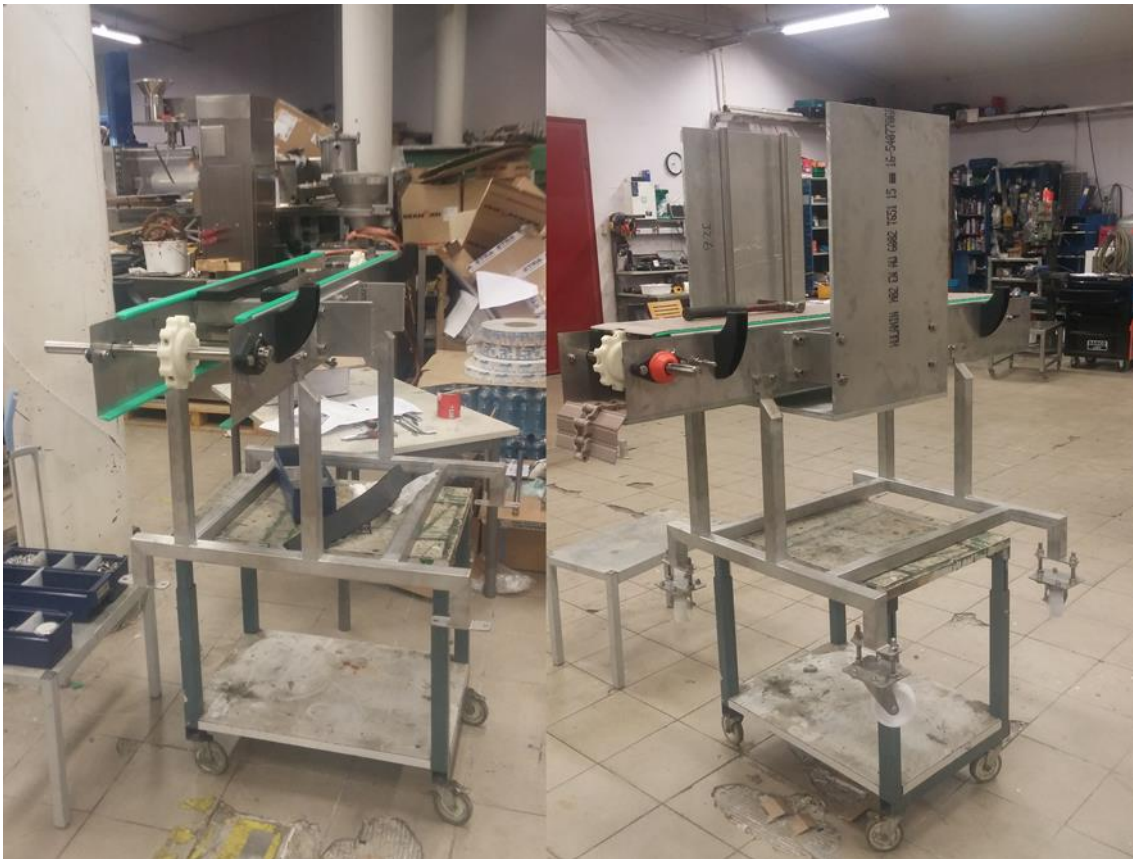
KUVA 16. Kuljettimen runko kiinnitetään kuljettimen jalkoihin
