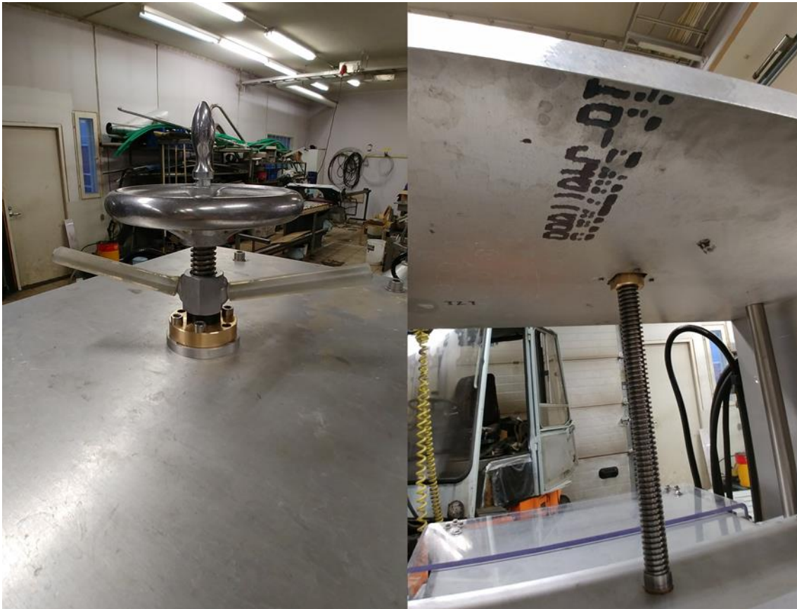
KUVA 22. Korjauksessa vaihdettiin uusi pronssinen laippamutteri ja koneistettiin ruostumattomasta teräksestä uusi trapetsikierretanko.
