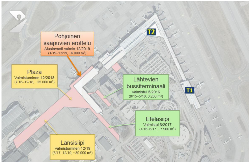
Kuva 2. Helsinki-Vantaan terminaalin laajennusosat. [5.]
