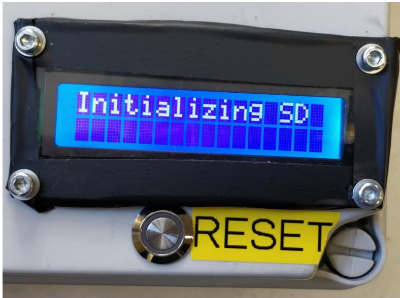
Kuva 31. SD-muistikortin tarkastus on ilmoitettu LCD-näytöllä
