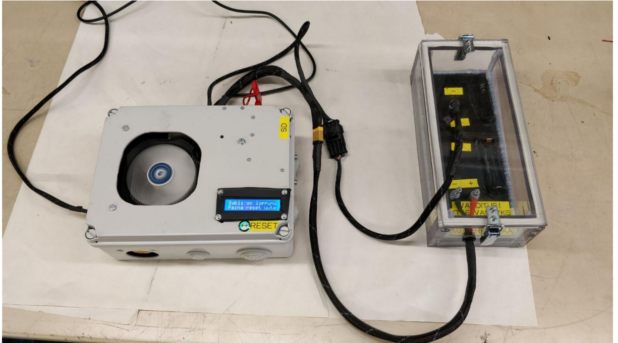
Kuva 42. Elektronikka-alustaohjattu akkukennotesteri ja testialusta
