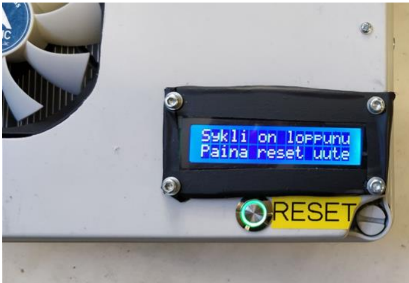
Kuva 32. Akkukenttesteri odottaa käyttäjältä Reset-painikkeen käyttöä
