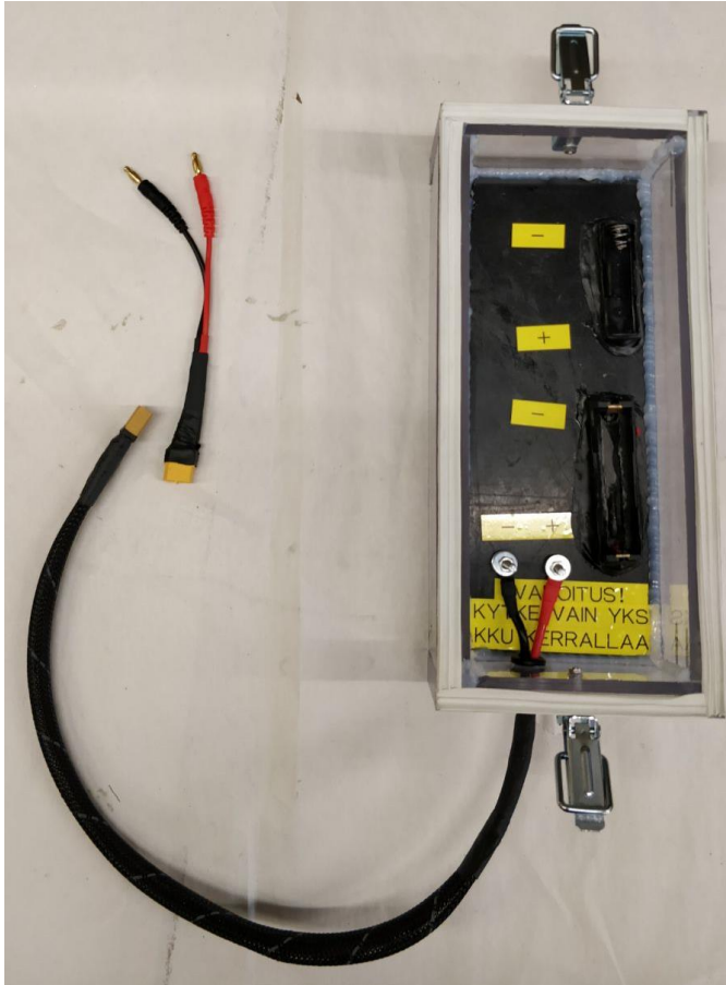
Kuva 35. Testialusta ja virtalähdettä varten luotu johto XT60-liittimillä
