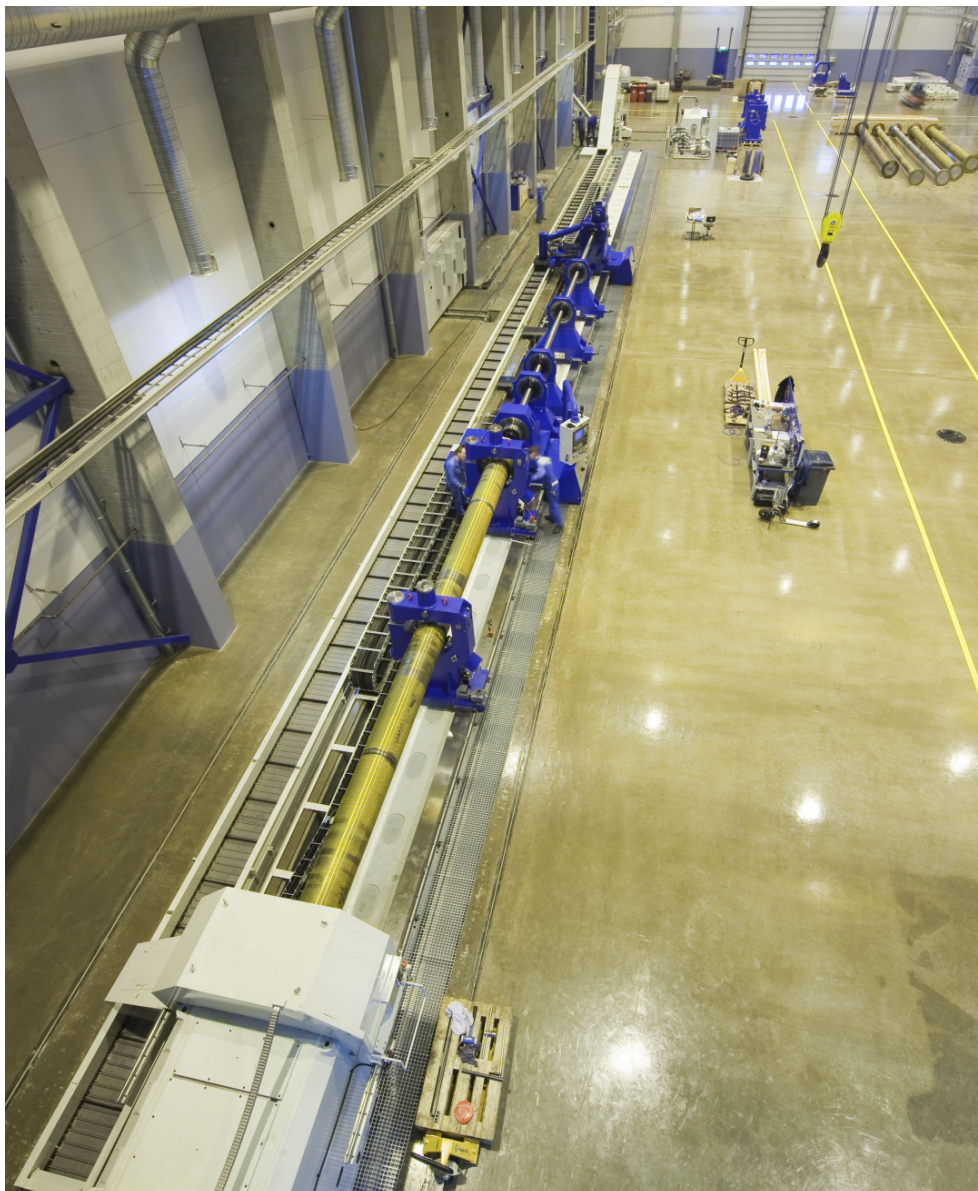
Kuva 10.2 Syvänreiänporakone TACCHI MOD. FT 110-LS suurin pyörintähalkaisija 2400 mm ja porattavan reiän pituus 25 500 mm.
