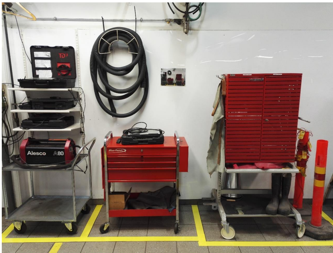
Kuva 27. Testerit, induktiolämmitin ja korkeajännitetyökalupakki uudelle sijainnille järjestettynä.
