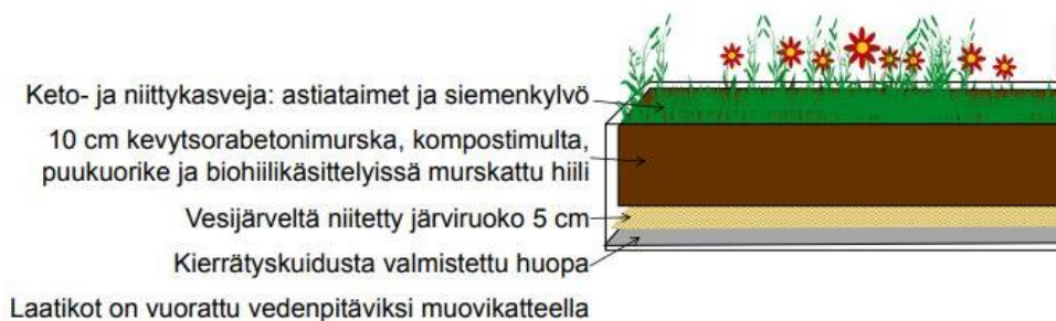
Kuva 3. Viherkaton rakenne (Kuoppämäki Kirsi).
