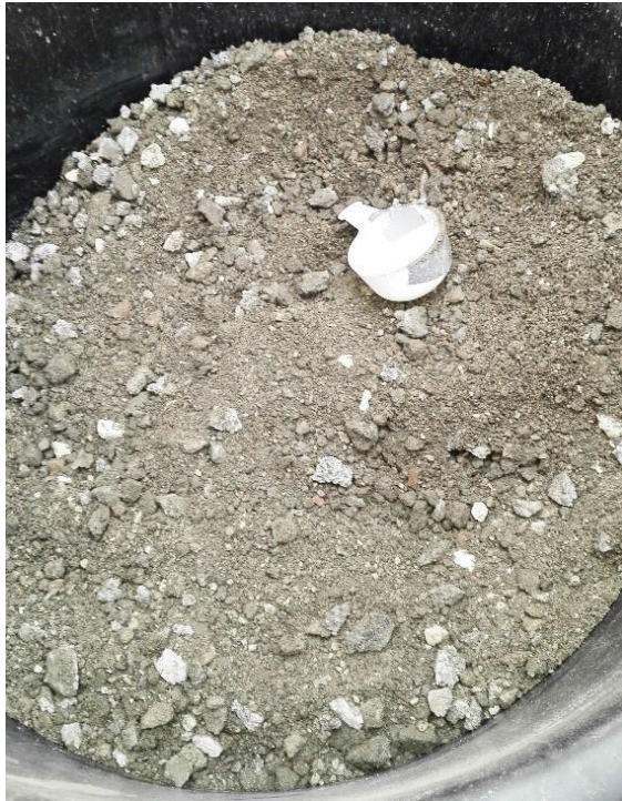
Kuva 1. Tuotannon sivutuotteena syntyvä kevytsorabetoni (Kuoppamäki 2017).
