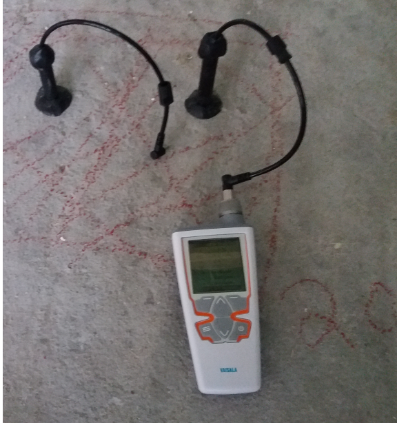
KUVA 2. Vaisala HM40 lukulaite ja HMP40S mittapäät tiivistettyinä porareikiin asennetuissa putkissa
