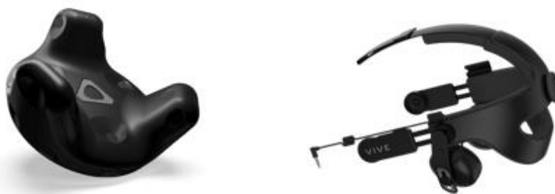
Kuva 8. Vive Tracker & Vive Deluxe Audio Strap (HTC Corporation© 2018h)
