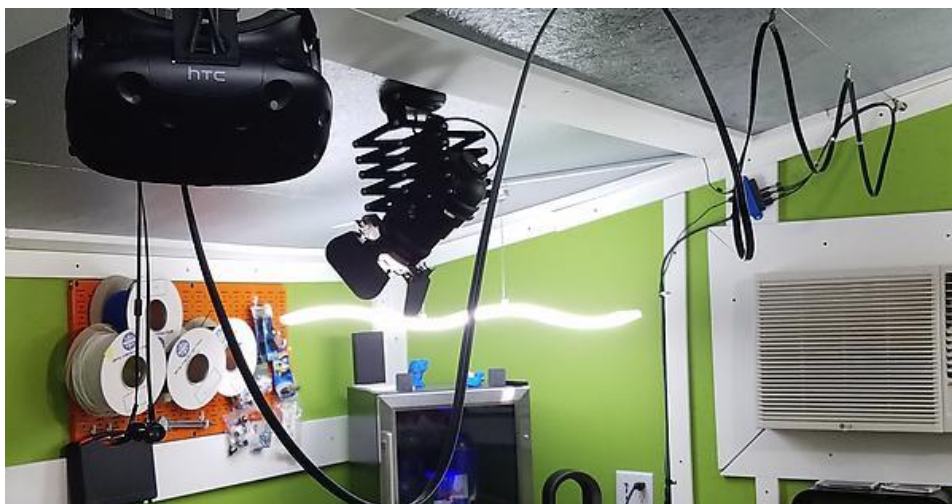
Kuva 9 Esimerkki johtojen kaapeloinnista kattoon HTC Vivelle (Imgur 2016).
