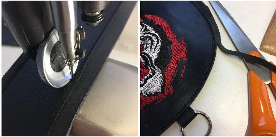
Kuva 44. Vuoripalojen ompelua päällisiin. Varojen leikkuuta.
