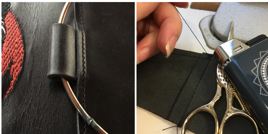
Kuva 43. Lämpän ja takakappaleen yhdistys. Samalla kiinnittyi metallinen kantokahva. Langanpäät viimeistelin solmimalla ja polttamalla.
