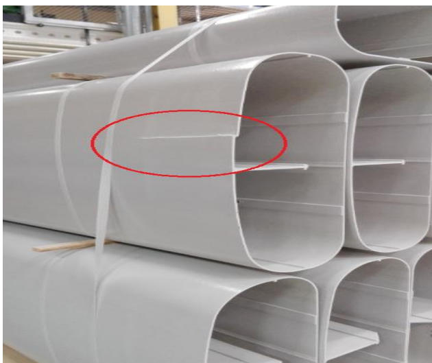
Kuva 3. CNC-työstökoneelta pakkaamoon siirretty tuotelava, jossa vioittunut tuote.
