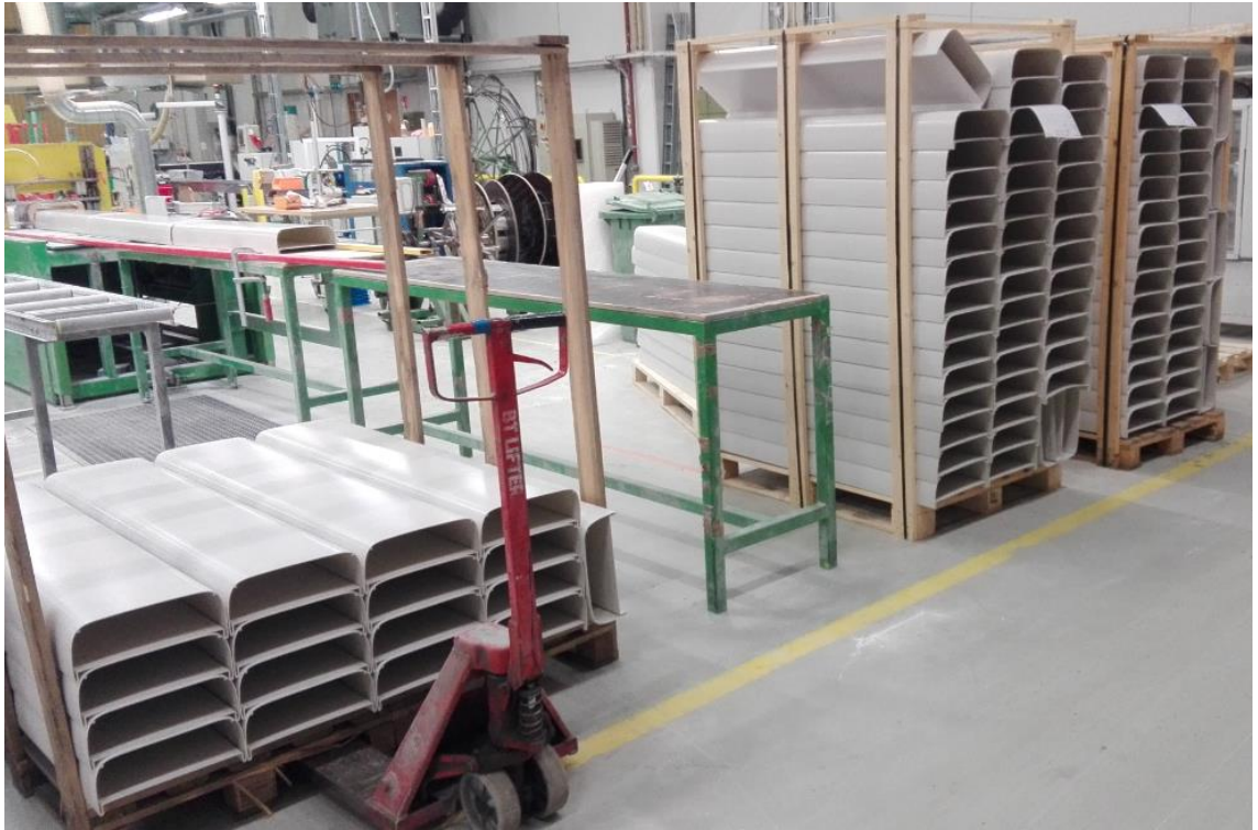
Kuva 18. Tuotehäkit estävät pääsyn tuotantolinjoille kuvan osoittamasta suunnasta.
