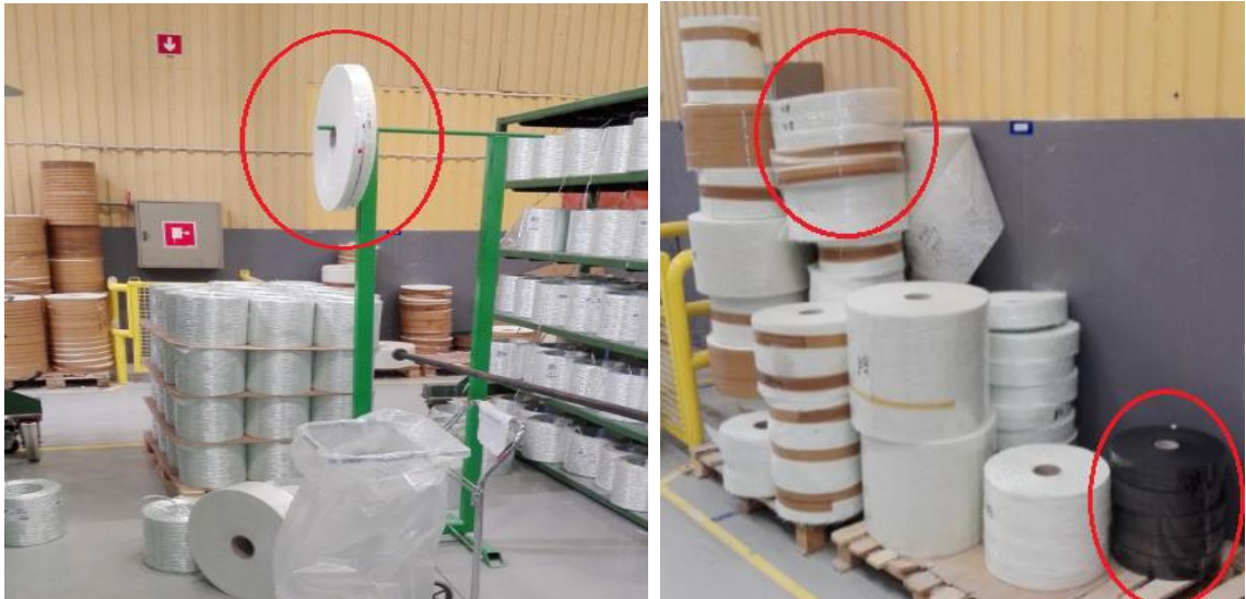
Kuva 31. Lasimatot ei määrättyllä paikalla. Kuva 32. Lasimatoista muodostuu ”mattotorneja”.
