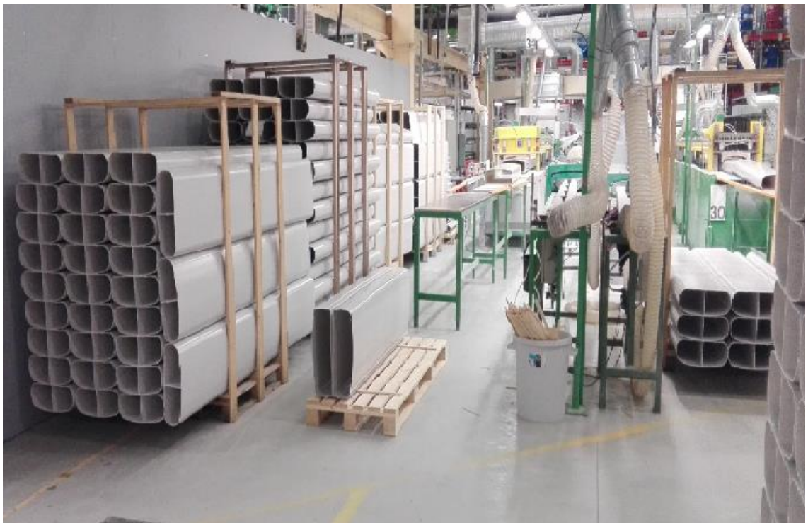
Kuva 15. Tuotantolinjojen 34 ja 35 välinen välivarasto on täynnä keskeneräistä tuotantoa.
