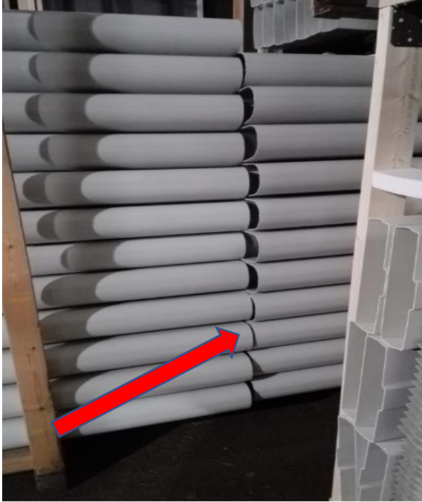
Kuva 10. Tuotteiden päät osuneet toisiinsa, jonka johdosta syntyi vioittuneita tuotteita.
