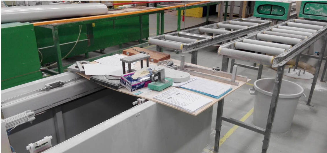
Kuva 37. Mittavälineet ovat epästabiililla ”työtasolla”.
