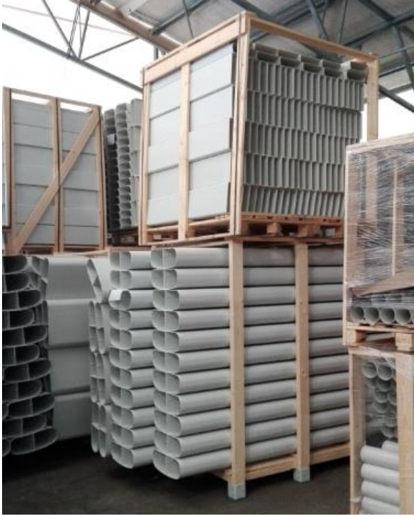
Kuva 11. Eri tuotehäkkejä pinottu päällekkäin, josta aiheutuu turhaa siirtelyä.
