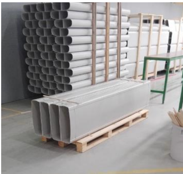
Kuva 1. Tuotteet pakattu vääränkokoisille lavoille.
