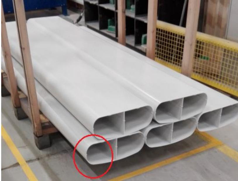
Kuva 8. CNC-työstökoneelle kuljetettu tuotehäkki, jossa vaurioitunut tuote.
