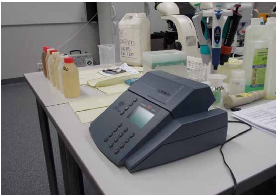
Kuva 14. Karelia-ammattikorkeakoulun filtterifotometri, Jukajoen alueen vesinäytteitä ja muita laboratoriotöiden välineitä lokakuussa 2015. Sirkkalan laboratorioluokka, Joensuu.
