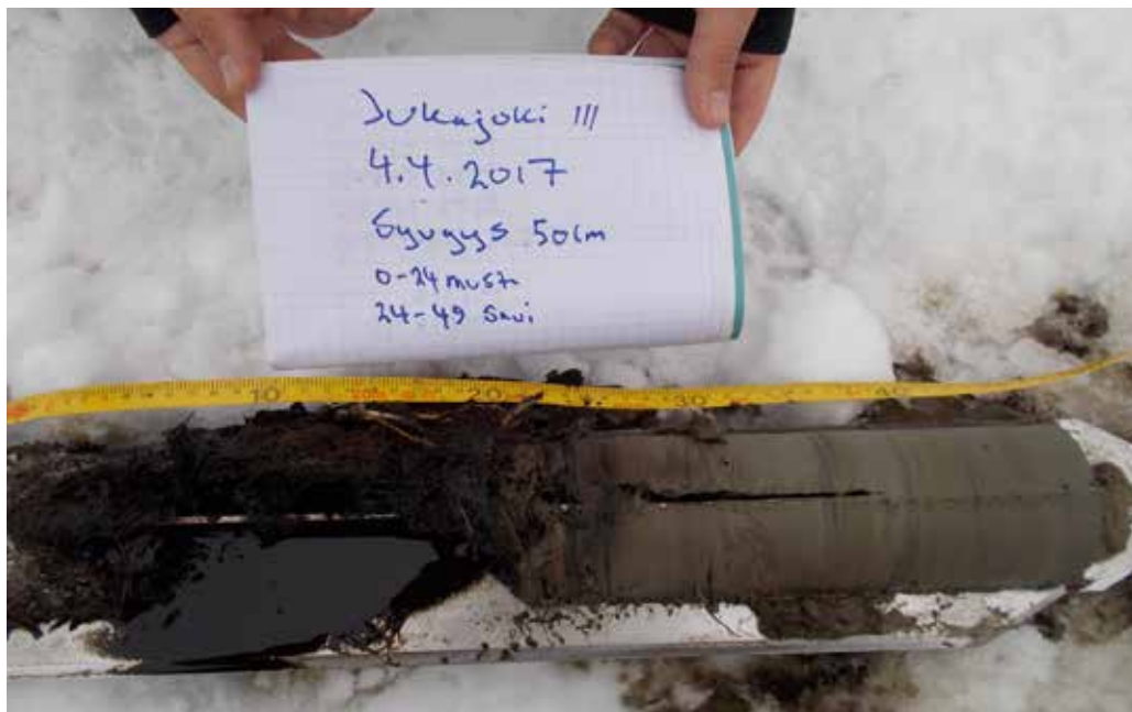
Kuva 146. Jukajoen suistoalueelta (pengersillalta hiukan alajuoksuun päin, ks. myös kuva 144) otettu sedimenttinäyte. Näytteenottoaika sijaitsee alkuperäisellä metsämaalla ennen vuotta 1971, ts. ennen Kuurnan voimalaitoksen aiheuttamaa vedennousua Pielisjoessa ja Jukajoessa, ja siis nykyisellä vesialueella (vrt. myös kuva 139).
