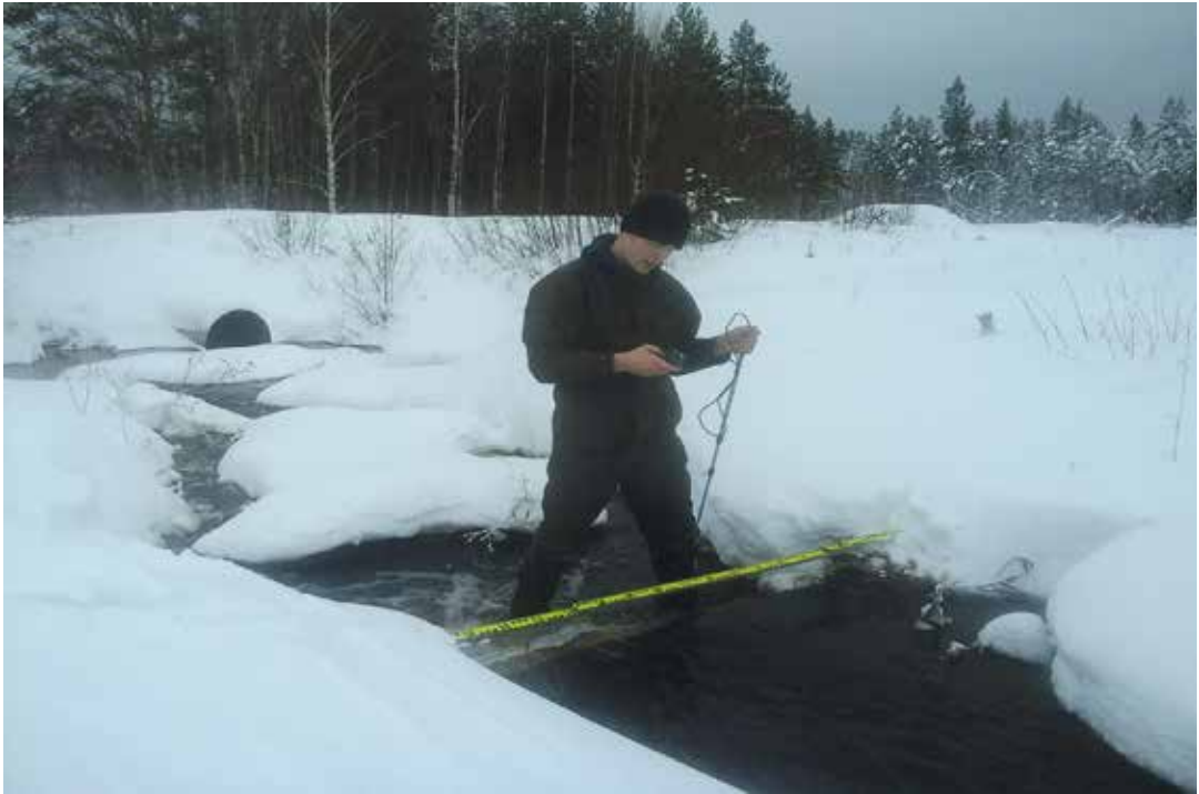
Kuva 43a. Karelia-ammattikorkeakoulun insinööriopiskelija Panu Paloniitty mittaa Linnunsuon kosteikosta lähtevän uoman virtaamaa sveitsiläisvalmisteisen Flowwatch™ -siivikon avulla joulukuussa 2016.
