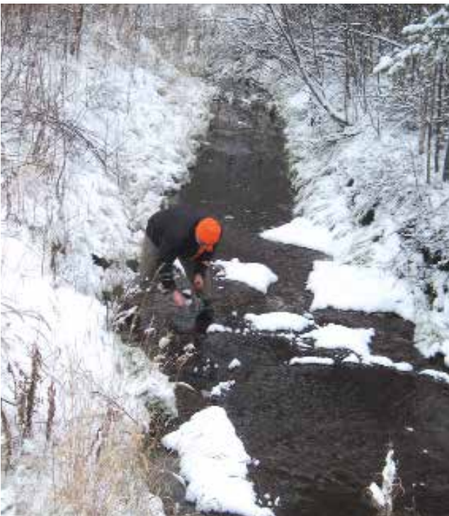
Kuva 43. Tarmo Tossavainen ottaa vesinäytteitä Linnunsuon turvetuotantoalueen eteläisen laskeutusaltaan lähtevästä uomasta lokakuun lopulla 2012. Kuva: Sanna Louhelainen.
