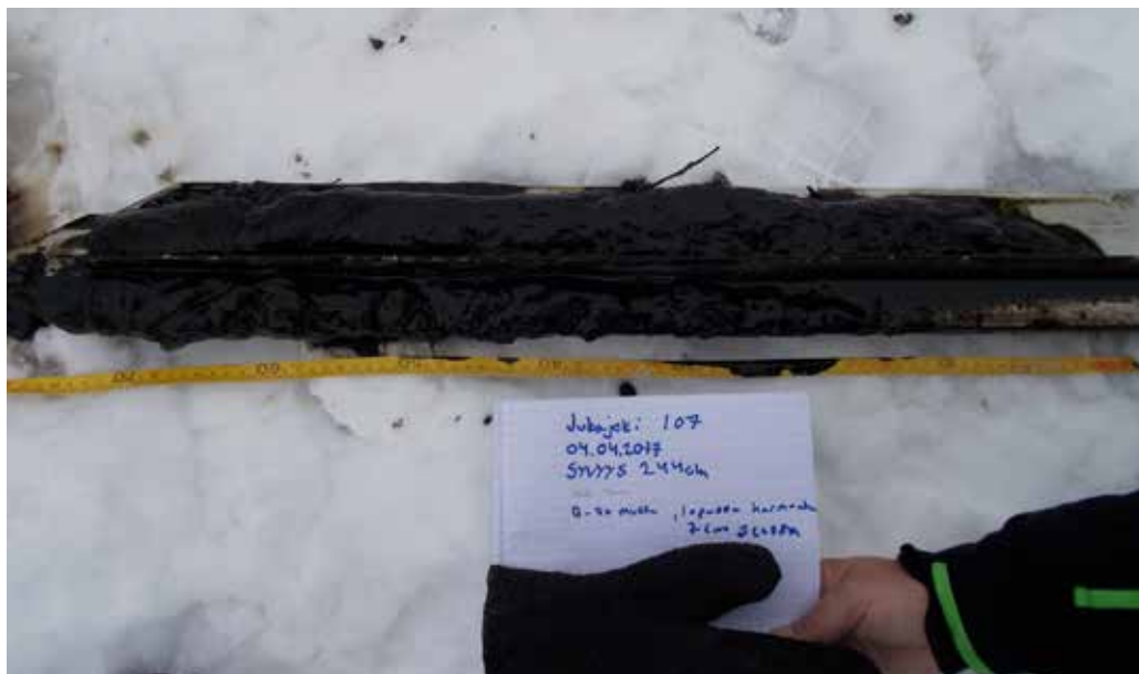
Kuva 145. Jukajoen suistoalueelta (pengersillalta hiukan alajuoksuun päin; ks. kuva 144) alkuperäisestä jokiuomasta otettu sedimenttinäyte huhtikuussa 2017. Näyte; noin 70 cm vesipitoista, mustanruskeaa liejua, jonka alapuolella kova, harmaa savi.
