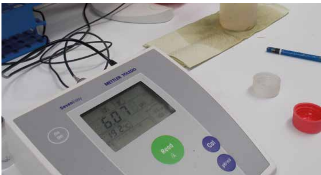
Kuva 14 a. Veden happamuusaste (pH) mitattiin Mettler Toledo EasySeven -laitteella Karelia-ammattikorkeakoulun Sirkkalan laboratorioluokassa.
