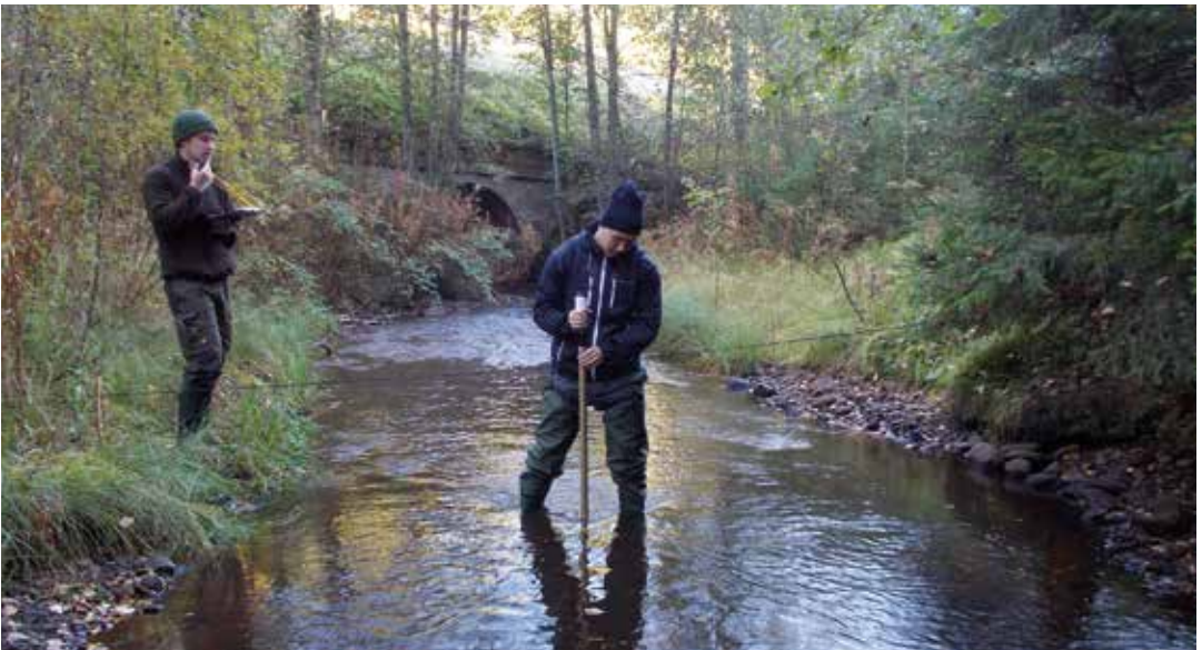
Kuva 13. Karelia-ammattikorkeakoulun opiskelija Joose Korhonen mittaa yhdysvaltalaisvalmisteisella Global Water® -siivikolla Jukajoen virtausnopeutta virtaaman laskentaa varten Ilomantsintien havaintopaikalla syyskuussa 2014. Kirjurina toimii opiskelija Ilkka Saloranta.
