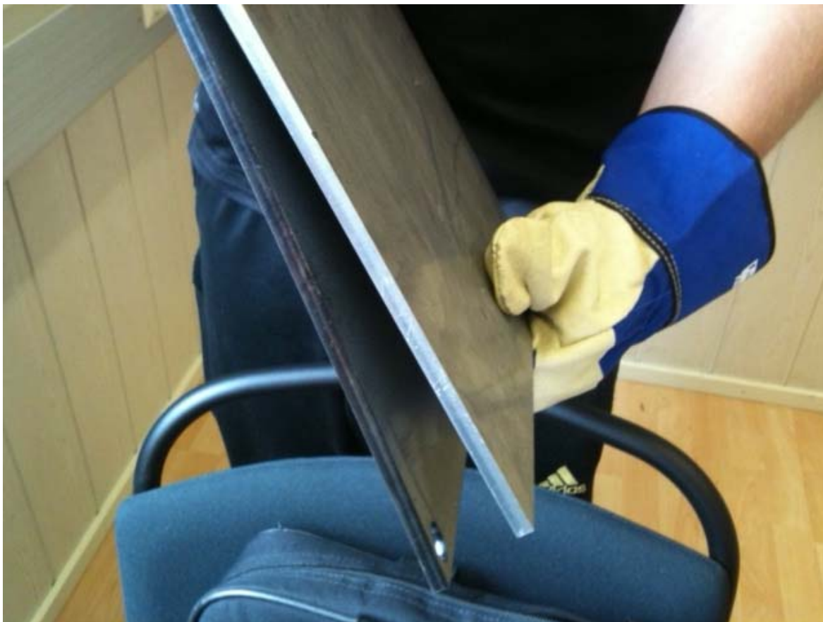
Kuvio 2. Oksidinpoisto, oikeanpuoleinen levy käsitelty, vasemmalla oleva on käsittelemätön. (Ripatti 2018.)
