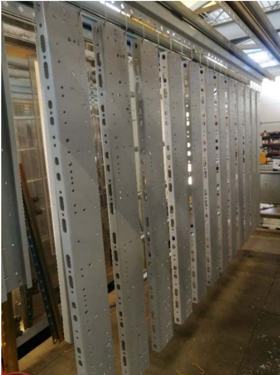
Kuvio 5. Valmiiksi maalattuja osia ripustustelineessä. (Trailander 2018).
