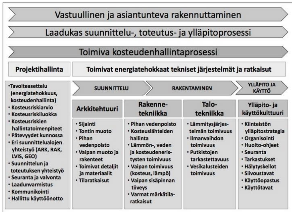
Kuva 3. vastuullinen ja asiantunteva rakentaminen. (Kosteudenhallinta.fi.)
