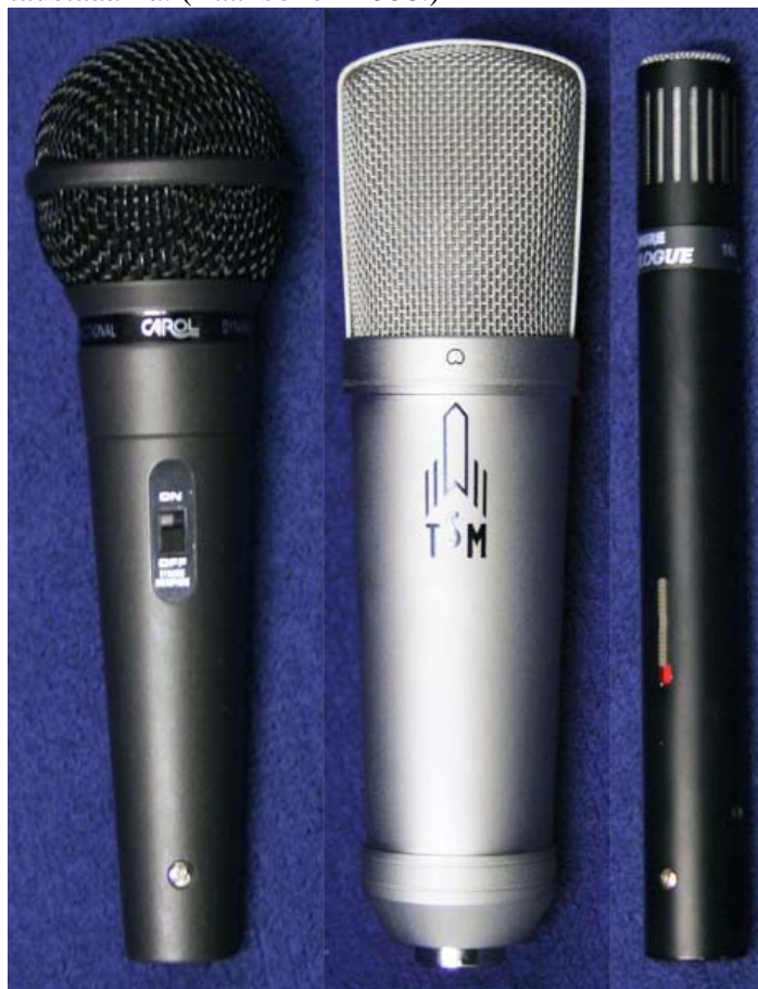
KUVA 6 Erityyppisiä mikrofoneja. Kuvassa vasemmalta: dynaaminen mikrofoni, isokalvoinen kondensaattorimikrofoni ja pienikalvoinen kondensaattorimikrofoni.
