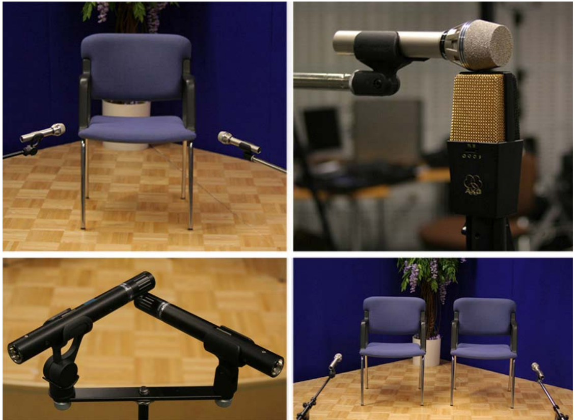
KUVA 8. Erilaisia stereopariasetelmiä. Kuvassa vasemmalta ylhäältä: CAP, MS, XY, A/B.
