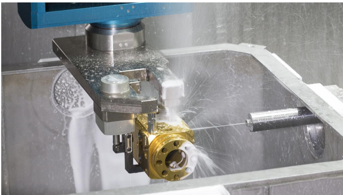
KUVA 11. Esimerkki vesijäysteenpoiston solusta, jossa suutin on asennettu kiinteästi. Kuvassa on käytössä 245 MPa:n vesisuihku (Sugino 2018, muokattu)
