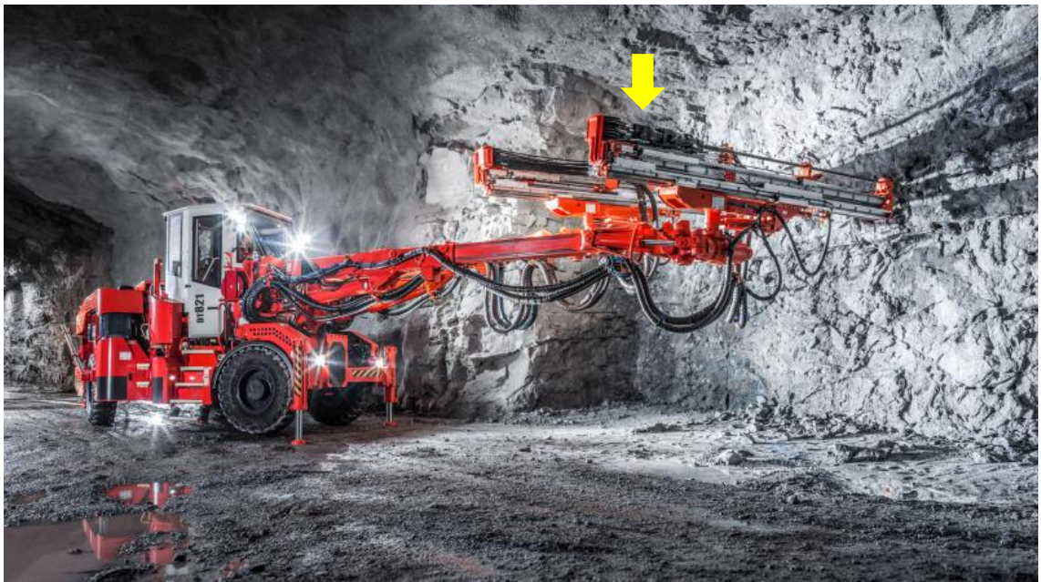
KUVA 2. DT821 Tunnelijumbo, jossa kallioporakoneen sijainti esitetty nuolella (Sandvik Mining 2018, muokattu)
