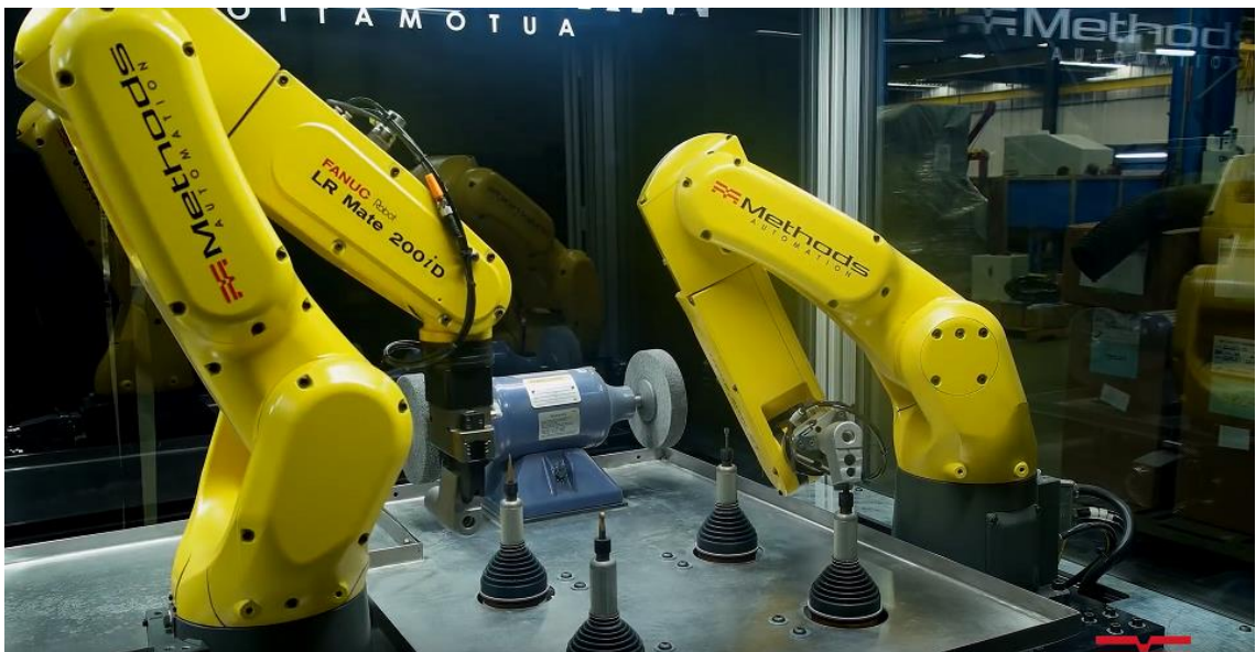
KUVA 9. Esimerkki jäysteenpoistosolusta, jossa on käytössä erilaisia pyöriviä viilateriä sekä pöytähiomakone (Methods Machine 2018, muokattu)
