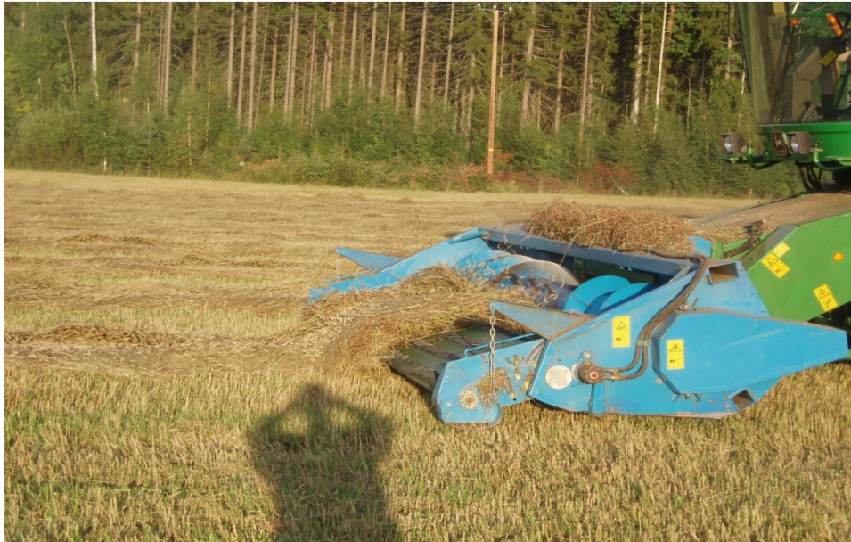
Kuva 2. John Deere CTS 320 -rumpupuimuri, johon on liitetty erillinen noukinpöytä.
