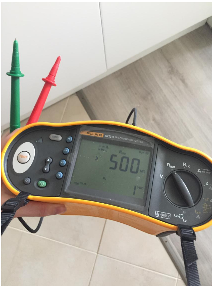
Kuva 10. Keskukselta mitatun eristysresistanssin mittaustulos
