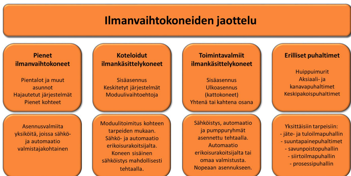
Kuva 5. Usein käytetty ilmanvaihtokoneiden jaottelu [15].
