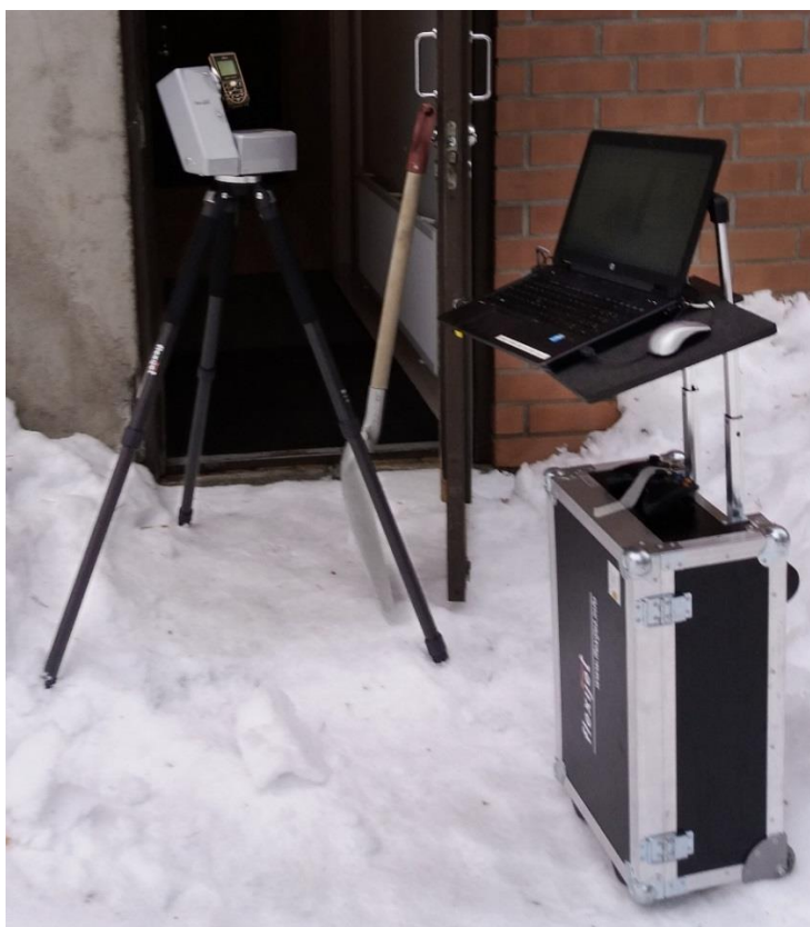
Kuva 2. Flexijet 3D -lasermittausjärjestelmä ulkokäytössä (Vepsäläinen 2017)
